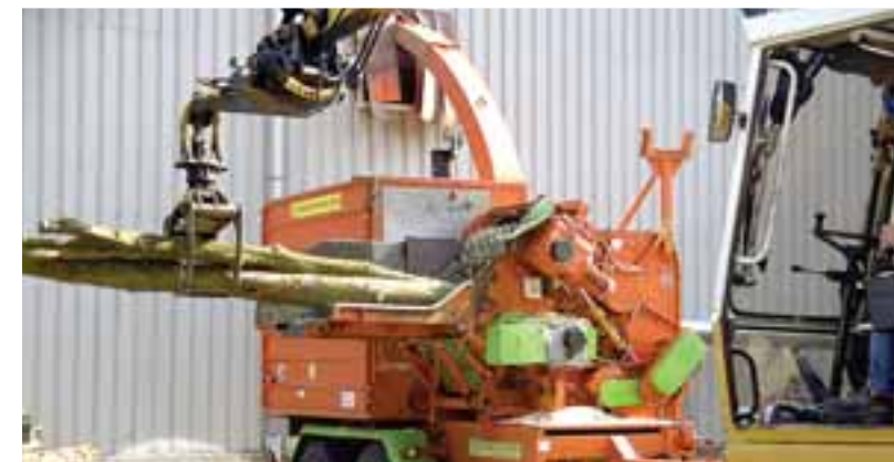
Мобильный приводной измельчитель мощностью 400 Вт (536 л. с.)
