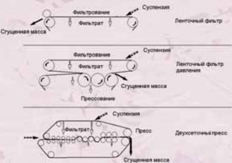
Рис. 2. Принцип действия ленточного фильтра, ленточного фильтра давления и двухсеточного прессы
