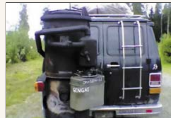
Современный автомобиль с кустарной газогенераторной установкой
