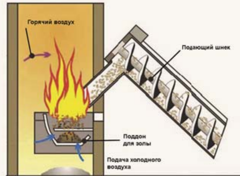
Традиционная схема подачи пеллетного топлива в мини-котельную
