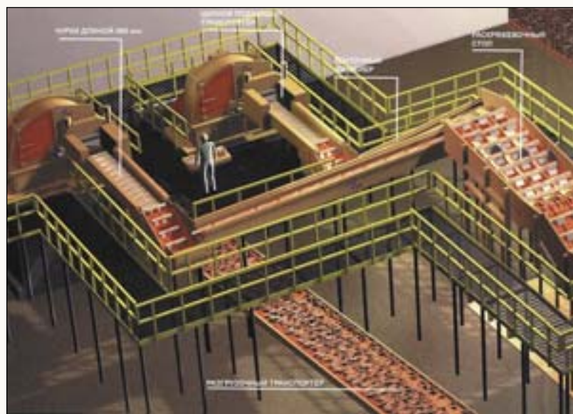
Рис. 3. Схема организации участка производства стружки на базе стружечных станков фирмы CAE (Канада)
