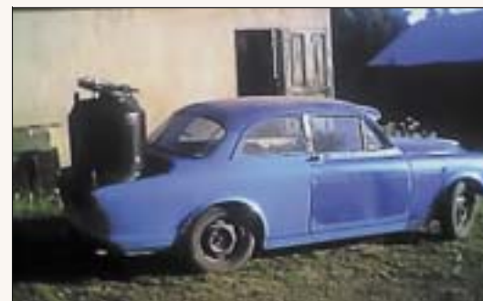
Рис. 3. Легковой автомобиль, переоборудованный на твердое топливо (Швеция, 1960 г.)
