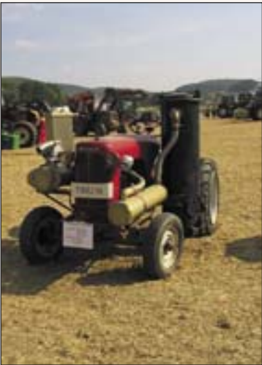
Рис. 9. Возрождение газогенераторных тракторов с газогенераторной установкой типа «Имберт» (Франция, 2004 г.)
