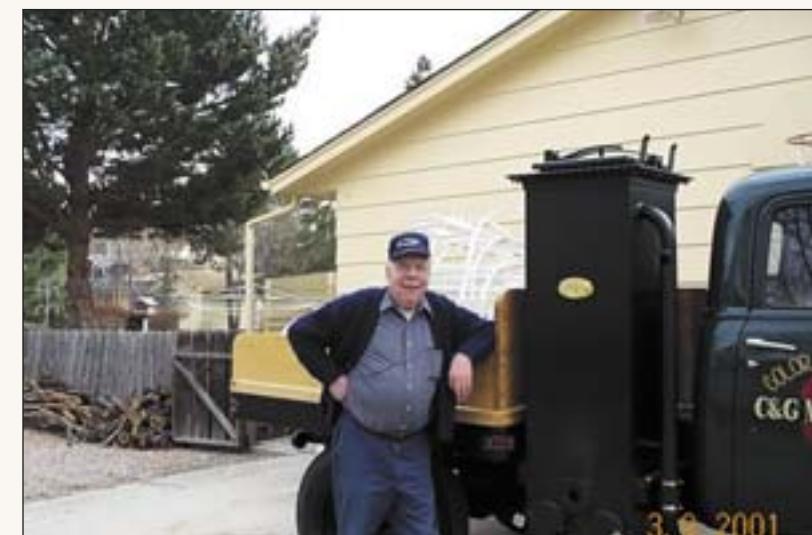
Рис. 2. Сохранившийся в работоспособном состоянии газогенераторный автомобиль (США 2001 г.)
