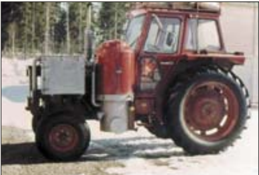
Рис. 7. Газогенераторный трактор с газогенераторной установкой типа «Имберт» (Швеция, 1976 г.)
