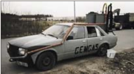
Рис. 5. Компонировка легкового автомобиля кустарной газогенераторной установкой (США, 1975 г.)
