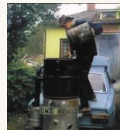
Рис. 4. Заправка газогенераторного легкового автомобиля с кустарной газогенераторной установкой (Швеция, 1972 г.)
