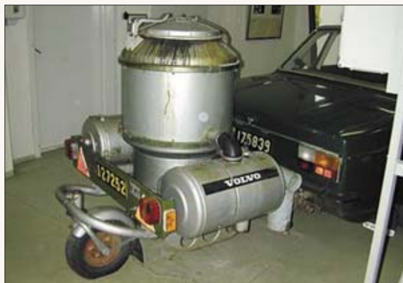
Рис. 10. Прицепная газогенераторная установка типа «Имберт» фирмы VOLVO (Швеция, 2002 г.)
