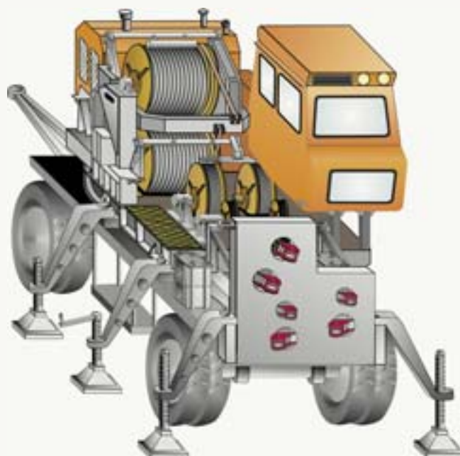
Рис. 3. Трелевочная лебедка ЛЗ-6 на прицепе
