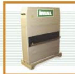
Непрерывный искатель твердых включений во избежание повреждения пресса
