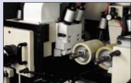
Передний пневматический прижимной ролик
