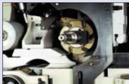
Доводка заточенных ножей методом прифуговки на шпинделе
