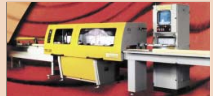
Модель торцовочного станка с устройством для оптимизации – новая версия оптимизатора Tdo 250
