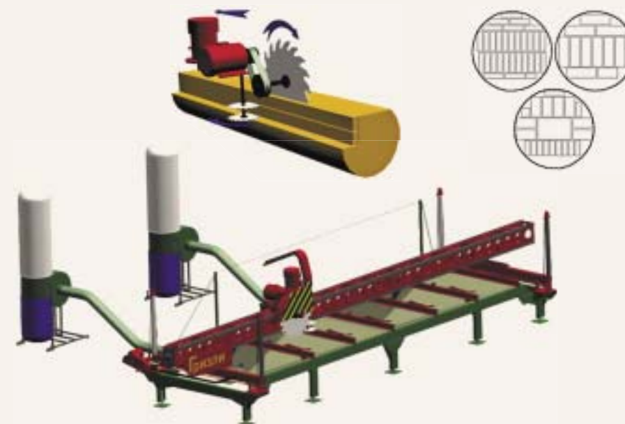
Рис. 2. Общий вид лесопильного станка «Гризли» с пылеотсосами
