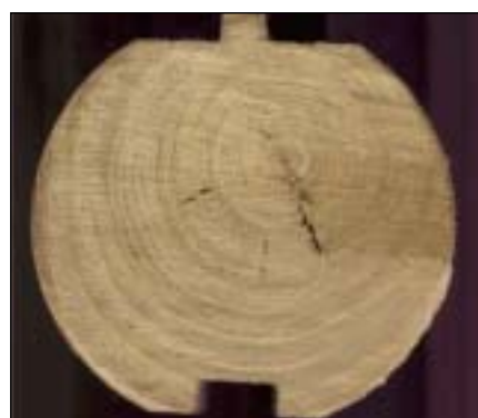
Рис. 4. Оцилиндрованное бревно лиственницы, высушенное СВЧ-способом до 10% влажности.
