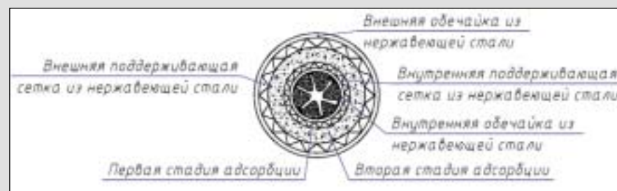
Рис. 2. Поперечное сечение фильтрующего элемента коалесцентного осушителя.
