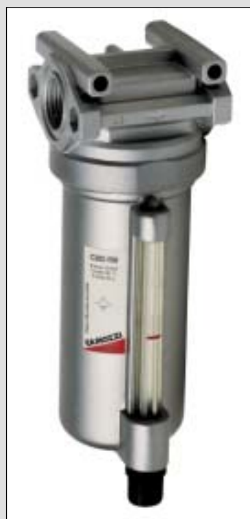
Рис. 3. Коалесцентный осушитель Camozzi. Присоединения G1/4, G3/8, G1/2, G1. Рабочая температура от 0°C до 50°C. Фильтрация 0,1/0,01 мкм.
