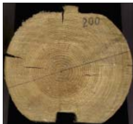
Рис. 5. Оцилиндрованное бревно лиственницы, высушенное под открытым небом до 25% влажности.
