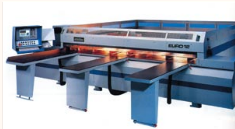
Рис. 3. Станок для раскроя плит с прижимной балкой
