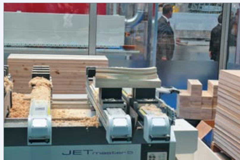
Рис. 2. Соединительный элемент поручня лестницы, обрабатываемый на станке с одновременным управлением перемещением инструмента по пяти пространственным координатам
