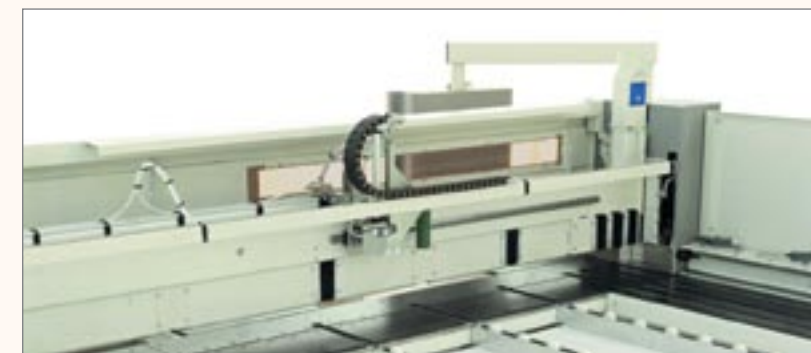
Рис. 6. Прижимная балка, стол с прорезью для прохода пилы и упорная линейка
