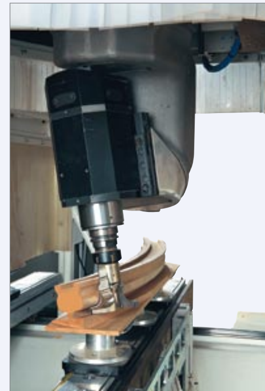
Рис. 3. Съемный агрегат обрабатывающего центра, обеспечивающий поворот инструмента относительно пятой оси (оси В)
