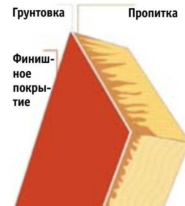
Трехслойная система окраски промышленными покрытиями Tikkurila
