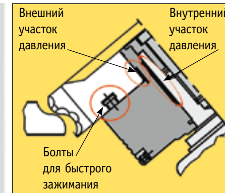
Рис. 8. Гидравлическая система быстрого зажима (двойного действия)
