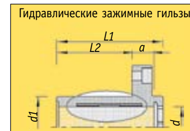
Рис. 7. Классические зажимные гильзы и гидравлические зажимные гильзы
