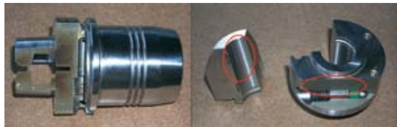
Рис. 4. Конструкция гидравлического зажимного патрона
