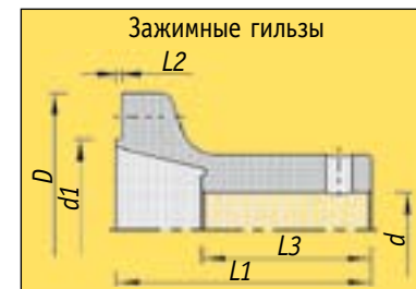
Рис. 7. Классические зажимные гильзы и гидравлические зажимные гильзы
