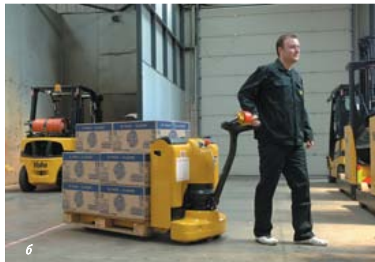
Рис. 3. Тележки с гидравлическим подъемом вилок: а – с ручным перемещением; б – с электроприводом
