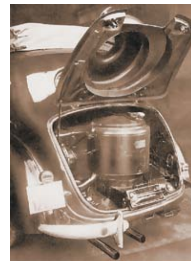
Рис. 3. Компонировка газогенераторной установки на автомобиле «Вандерер-W23» (1939 год)
