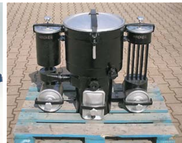
Рис. 2. Газогенератор «Васкер» для легковых автомобилей
