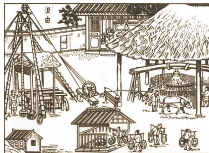
Рис. 4. Древняя буровая установка для добычи природного газа (Китай, провинция Сычуань, II в. н. э.)
