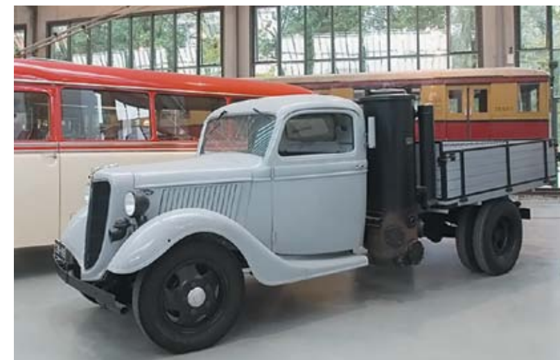
Рис. 4. Газогенераторный автомобиль Ford, 1937 год
