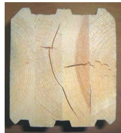
Рис. 1. Растрескивание клееного бруса в торцах [1]
