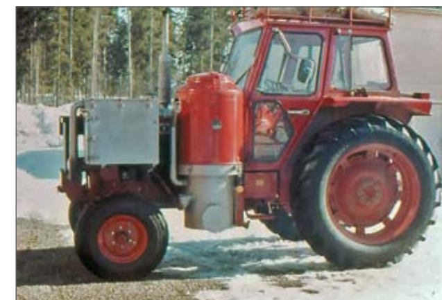
Рис. 9. Газогенераторный трактор Volvo (газогенератор модели F-500), 1979 год
