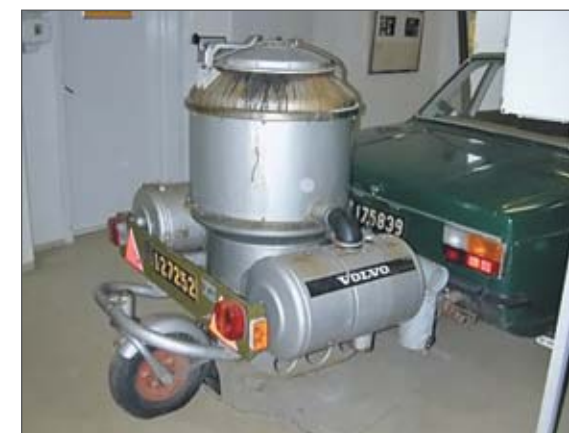
Рис. 8. Прицепная газогенераторная установка Volvo (модель F-300), 1980 год
