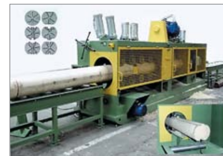
Рис. 7. Оцилиндровочно-фрезерный станок типа DNFA с одной оцилиндровочной головкой и двумя фрезерными системами
