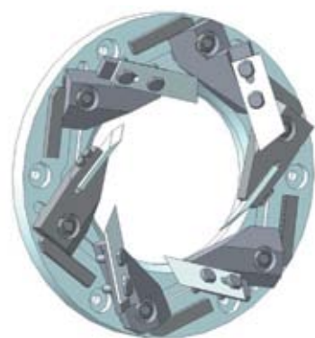
Рис. 4. Схема устройства круглой фрезерной головки с закрепленными по периметру ножами
