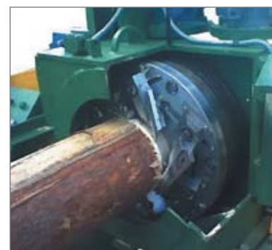
Рис. 5. Принцип работы фрезерного окорочного станка с круглой фрезерной головкой компании «Шервуд» (Россия)
