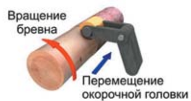
Рис. 9. Схема обработки поверхности сортиментов
