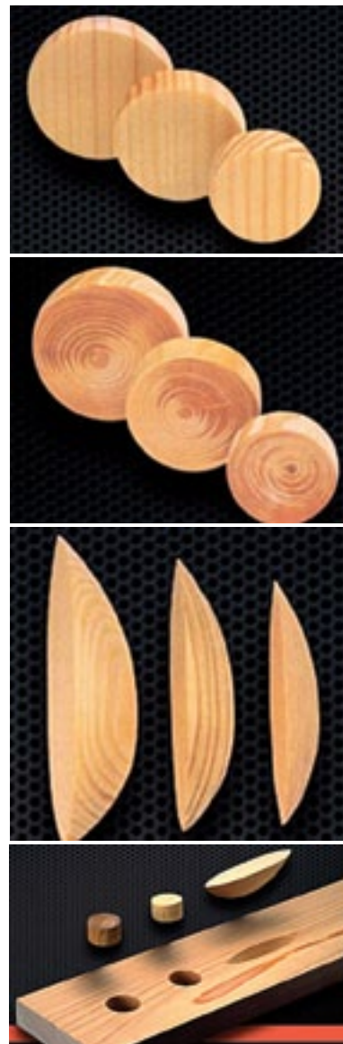
Рис. 1. Вставки для заделки пороков и дефектов: а – пробки с волокнами древесины, перпендикулярными оси; б – пробки с волокнами древесины, параллельными оси; в – одинарные (однократные) пробки-«лодочки»; г – гнезда под пробки
