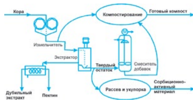
Рис. 3. Схема комплексной переработки коры хвойных деревьев
