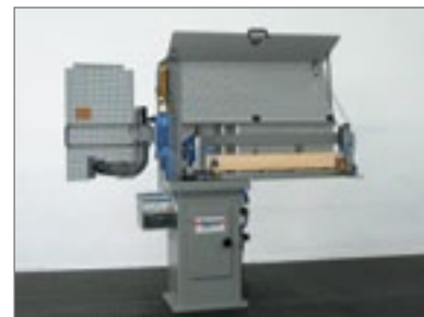
Рис. 1. Станок для изготовления цилиндрических вставок мод. QZF10
