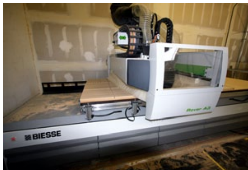
Рис. 4. Обрабатывающий центр для обработки брусковых деталей с механическими захватами на столе
