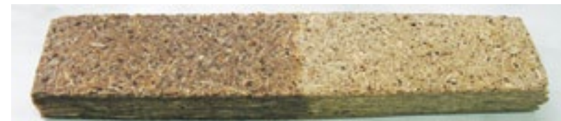
Образец ДСП, правая половина которого была обработана гидрофобизатором-композицией, после выдержки под слоем воды
