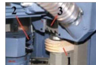
Рис. 3. Изготовление пробки-«лодочки» на станке: 1 – торец планки-заготовки, 2 – профильная фреза, 3 – отрезная пила
