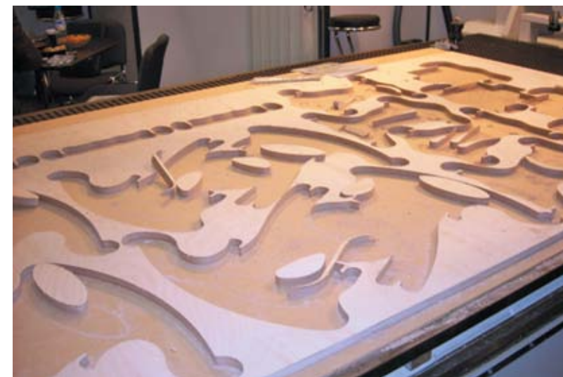
Рис. 6. Остаток листа клееной фанеры после вырезания из него деталей способом нестинга
