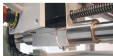
Рис. 2. Шариковинтовая пара и круглая направляющая для перемещения портала
