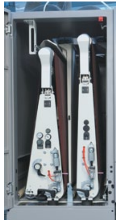
Регулировка давления для натяжения ленты с манометром
