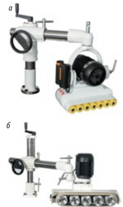
Рис. 4. Автоподатчики для деталей малой длины: а – с роликами уменьшенного диаметра; б – с резиновой гусеницей
