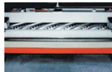
Спиральная режущая головка с 4-сторонними встроенными резаками
