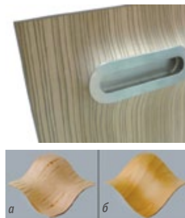
Рис. 1. Плоская деталь с выпуклым участком, которая облицована шпоном, пластифицированным по технологии фирмы Reholz; а) результаты облицовывания выпукло-вогнутой поверхности обычным б) пластифицированным шпоном
