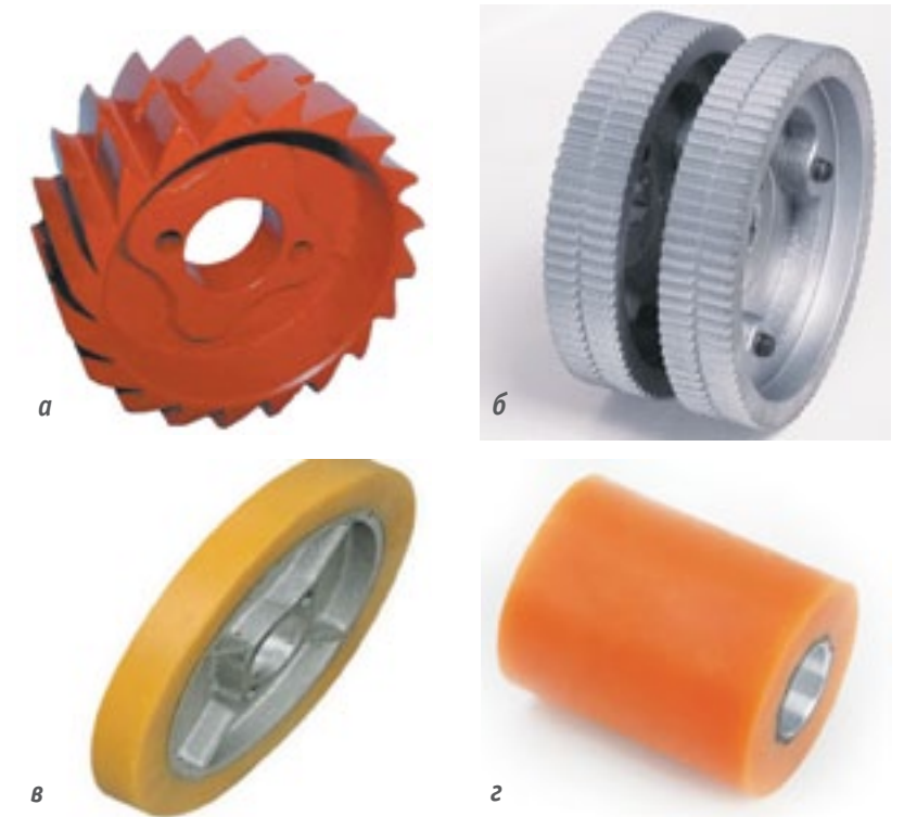
Рис. 2. Ролики к автоподатчикам универсального назначения: а – цельнометаллический ролик с зубцами большого размера для подачи пиломатериалов; б – сдвоенный цельнометаллический ролик; в – узкий обрезиненный ролик; г – широкий ролик с покрытием из полиуретана
