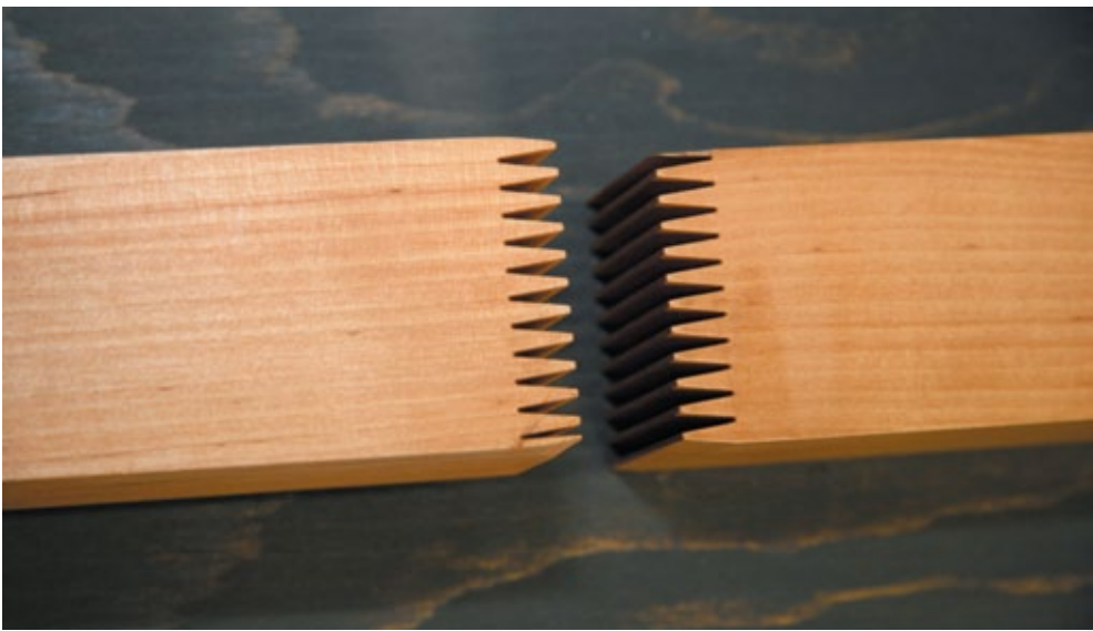
Рис. 1. Схема зубчатого клеевого соединения и образец одного из фрагментов заготовки с таким соединением
