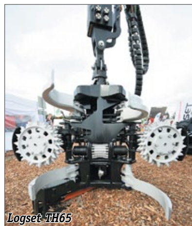
Дровокол с четырьмя вариантами раскола бревна. На выставке было представлено две модели нового вида оборудования, вызвавшего у финнов огромный интерес – навесного дровокола, устанавливаемого на гидроманипуляторе трактора
