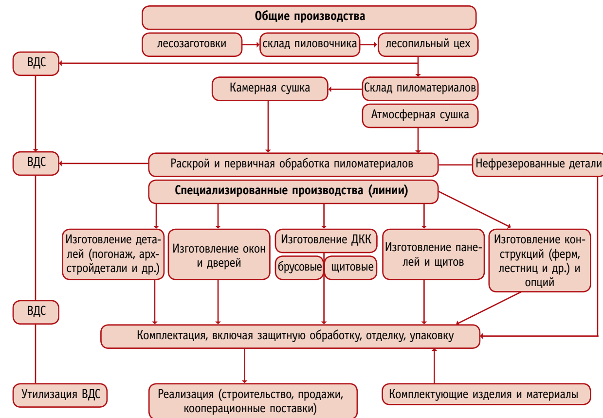
Рис. 1. Структурная схема гибкой технологии малоэтажного домостроения
