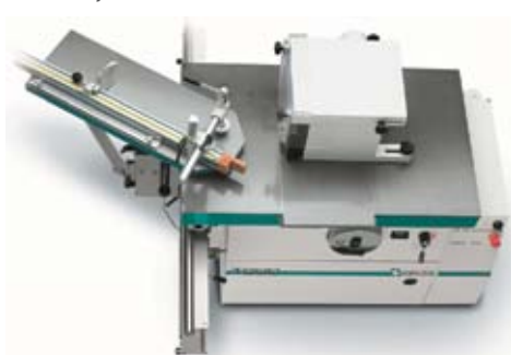
Рис. 2. Станок вертикальный фрезерный с нижним расположением шпинделя, оснащенный кареткой с поворотной линейкой
