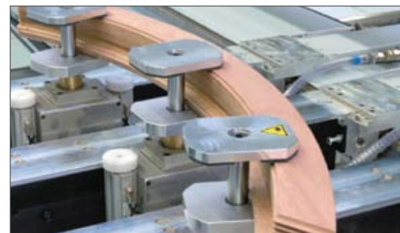
Рис. 5. Клеммные захваты для закрепления брусковой детали на столе обрабатывающего центра
