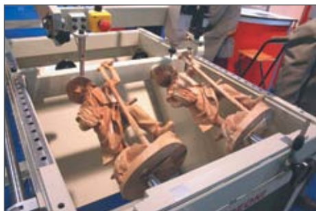
Рис. 3. Станок объемно-копировальный с концевыми фрезами
