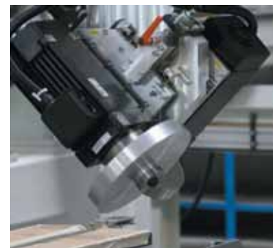
Рис. 4. Суппорт для выборки клиновидного паза, оснащенный двумя наклоненными пилами
