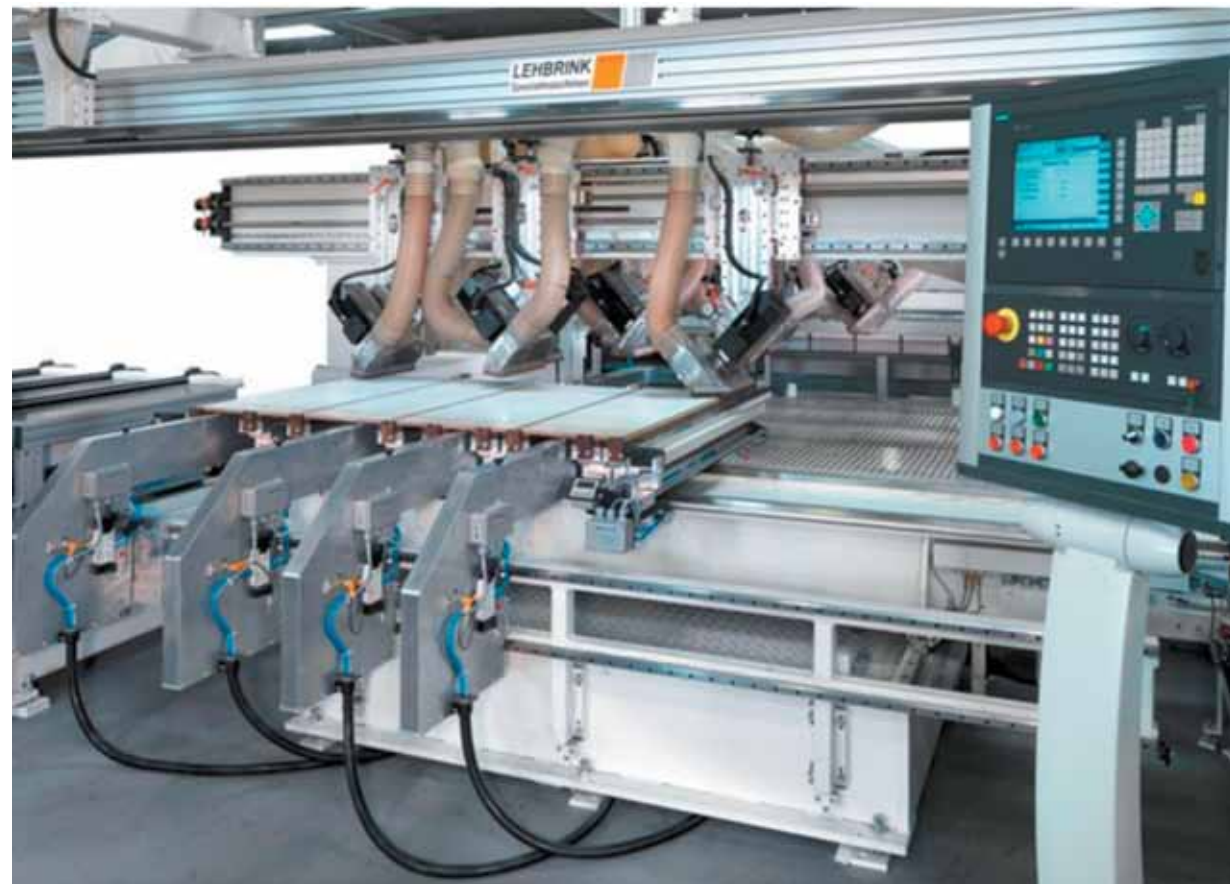
Рис. 3. Станок для выборки клиновидных пазов с поперечной подачей заготовок, оснащенный четырьмя суппортами с наклоненными пилами и дробилками
