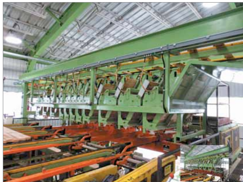
Рис. 21. Система Accustick фирмы Comact для подачи прокладок в магазины и укладки на пакет. Прокладки поступают в магазины по конвейеру. Производительность – до 20 циклов в минуту. Система может быть дополнительно оснащена сканером для обнаружения и удаления из потока поврежденных прокладок
