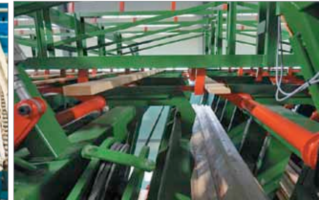
Рис. 17. Разные виды сортировочных конвейеров для вертикальных карманов: слева – с перемещением пиломатериалов крюками и сбросом в карман за счет опрокидывания крюка или выдвигания упора, снимающего сортимент с крюка (на фото – линия сортировки на Лесозаводе № 25); справа – с толканием пиломатериалов упорами и сбросом за счет открывания клапана кармана (на фото – линия Hekotek на заводе «Лесплитинвест»). Перемещение упорами является более перспективным решением, позволяющим достигать производительности до 250 штук в минуту
