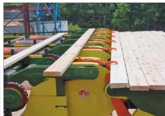
Рис. 3. Устройство роторного типа канадской фирмы PLC. Пиломатериалы захватываются сверху и снизу, передаются на короткий промежуточный конвейер, с которого почти сразу подхватываются упорами основного конвейера. По данным фирмы, к настоящему моменту ею изготовлено около 400 подобных устройств. По лицензии PLC в Европе подобные устройства изготавливает шведская компания Framtec
