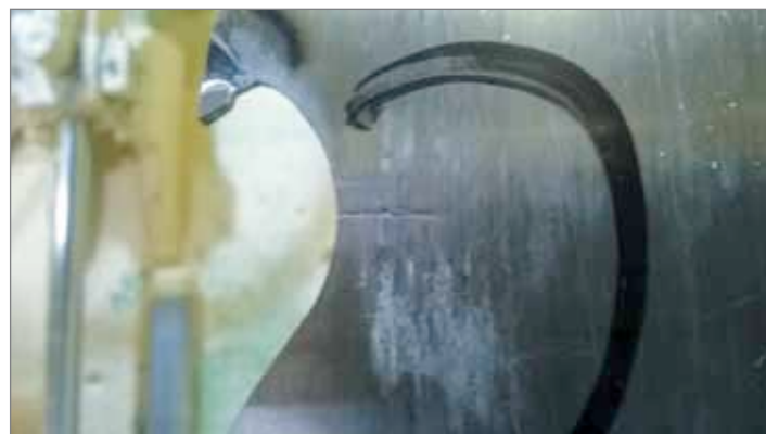
Рис. 3. Трещина на напаянной твердым сплавом ленточной пиле
