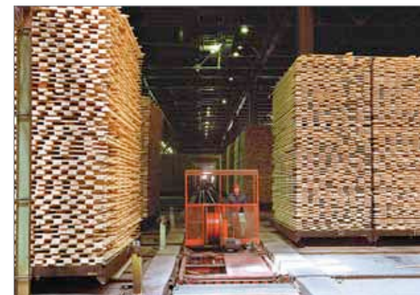
Рис. 25. Высокие сушильные штабели на рельсовых тележках и электротележка для распределения штабелей по камерам
