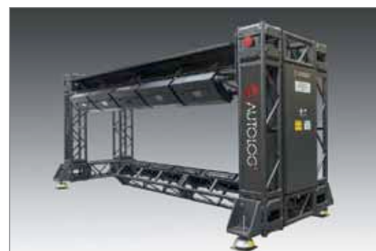
Рис. 10. У системы сканирования пиломатериалов фирмы Autolog имеется верхний и нижний ряды камер, нацеленных на конвейер под углом 45°. Система сканирует обе пласти и кромки пиломатериала без его переворота
