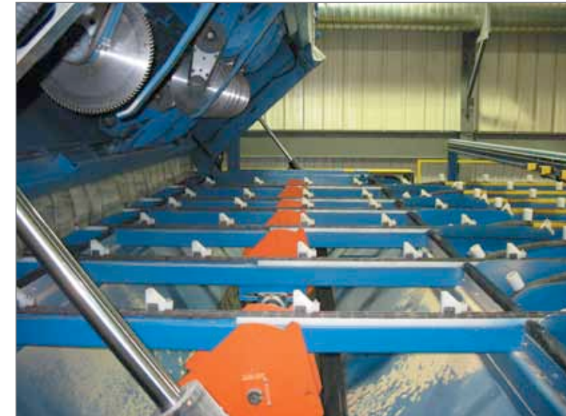
Рис. 13. Триммер Carbotech, открытый для обслуживания
