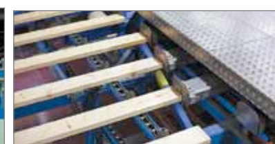
Рис. 6. Устройство позиционирования пиломатериалов по линии реза фирмы Renholmen. Пиломатериалы предварительно выравниваются торцами. Толкатели совершают движение вместе с потоком и устанавливают каждую доску в определенное положение относительно линии реза
