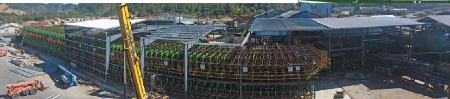
Рис. 16. Линия сортировки Piche: тот случай, когда карманов так много (110 шт.), что некоторую их часть приходится ставить с разворотом потока на 180°
