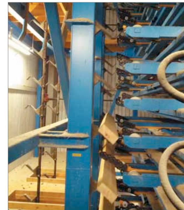
Рис. 18. Сортировочные конвейеры для распределения пиломатериалов по горизонтальным карманам: слева – вертикальный конвейер в линии Carbotech, пиломатериалы перемещаются на крюках элеватора сверху вниз, материал снимается с захватов выдвигающимися роликовыми шинами соответствующего кармана, по которым он соскальзывает на цепи; справа – наклонный конвейер в линии Brødbæk, пиломатериалы толкаются упорами наклонного конвейера, вход в карман закрыт клапаном, при раскрытии которого материал попадает внутрь, в противном случае проходит выше
