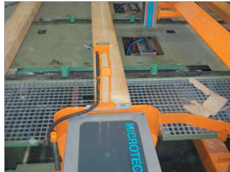
Рис. 14. Установка Microtec Viscan Plus на заводе Rettenmeier в г. Ullersreuth используется для сортировки сырых пиломатериалов по прочности. Завод производит пиломатериалы конструктивных сортов C18, C24 и C30. Сортименты, не отвечающие минимальным требованиям по прочности, отбраковываются, что позволяет не тратить ресурсы на их сушку
