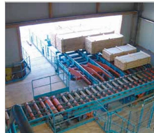
Рис. 24. Конвейеры для удаления сушильных пакетов в составе линии Hekotek
