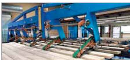
Рис. 2. Устройство поштучной выдачи фирмы Renholmen. Ленточные модули пневмоцилиндрами опускаются и поднимаются с заданным тактом, каждый раз подавая одну доску на проходящий упор расположенного за устройством конвейера. Эта система традиционной конструкции обеспечивает поштучную выдачу на упоры до 200 сортиментов в минуту (в зависимости от их сечения)
