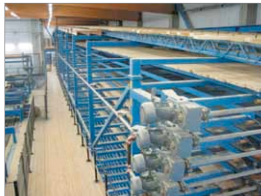
Рис. 19. Однослойное хранение пиломатериалов на этажах линии C. Gunnarssons Verkstad
