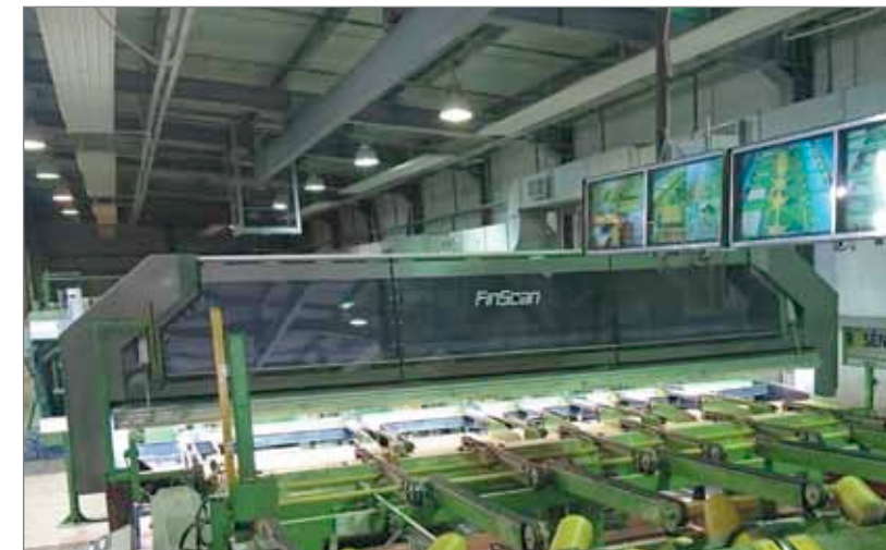
Рис. 11. Система сканирования пиломатериалов FinScan BoardMasterNOVA на предприятии «Красный Октябрь» в Перми. Светодиодные лампы освещают поверхности. Камеры с цветными матрицами наилучшим образом оценивают пиломатериалы с десяти направлений. Новейшие разработки фирмы FinScan позволяют осуществлять одновременное сканирование пиломатериалов со всех сторон без промежуточного переворота.
