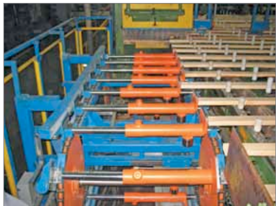
Рис. 7. В устройстве позиционирования Accu-Gate фирмы Carbotech реализован принцип постановки заслонки, по которой пиломатериал выравнивается торцом в соответствии с принятым решением о длине отрезаемого участка. Заслонки перемещаются на собственном конвейере синхронно с проходящими пиломатериалами
