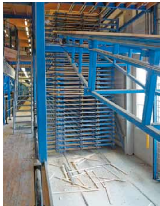
Рис. 20. Выгрузка пиломатериалов из кармана на конвейер с изменяемым углом наклона линии Carbotech
