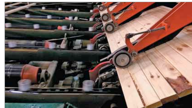
Рис. 4. Устройство поштучной выдачи Quad Cat фирмы USNR. Эксцентрики с заданным тактом цепляют нижний сортимент из магазина и передают на упоры конвейера. Устройство в большей степени предназначено для линий сортировки сухих пиломатериалов, но используется и в линиях сортировки сырых пиломатериалов
