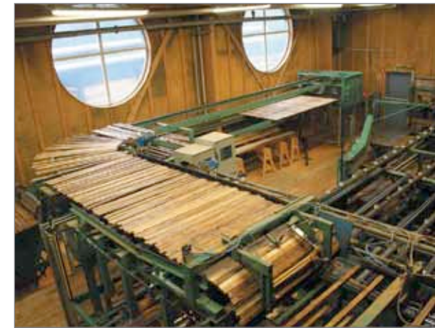
Рис. 23. Конвейеры для подачи сушильных прокладок к ПФМ на одном из шведских лесозаводов
