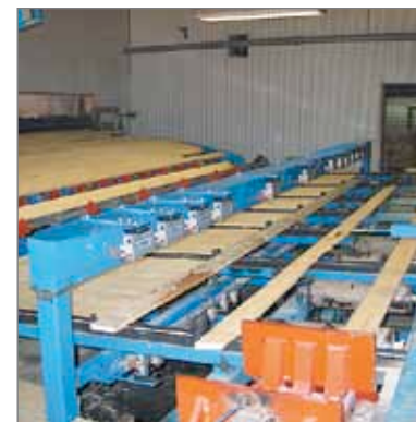
Рис. 9. Система 3D-сканирования BoardProfiler фирмы LIMAB в комбинации с системой позиционирования пиломатериала перед триммером. Имеется нижний ряд датчиков, что позволяет измерять обзол на любой пласти
