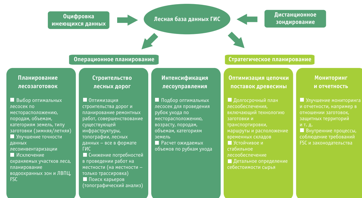
Рис. 2. Схема создания базы данных ГИС и ее использование в операционном и стратегическом планировании
