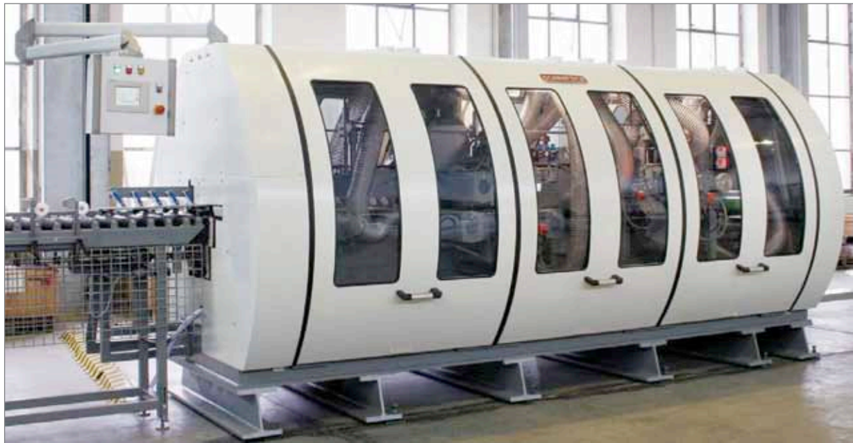
Рис. 6. Станок DU06-12F для профилирования многослойного паркета (Gebrüder Schroeder GmbH & Co. KG, Германия)
