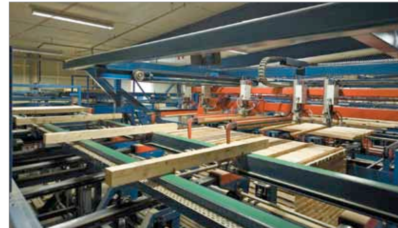
Рис. 22. Система подачи и укладки сушильных прокладок фирмы Altab. В состав системы входят конвейер, по которому прокладки поступают к ПФМ, с упорами, останавливающими их в нужной позиции, и порталный робот, который захватывает прокладки и укладывает их на пакет. Достоинством этой системы является возможность укладки как межрядовых, так и межпакетных прокладок, которые дозируются из разных буферов. Другие системы требуют ручной укладки толстых межпакетных прокладок или использования отдельного устройства
