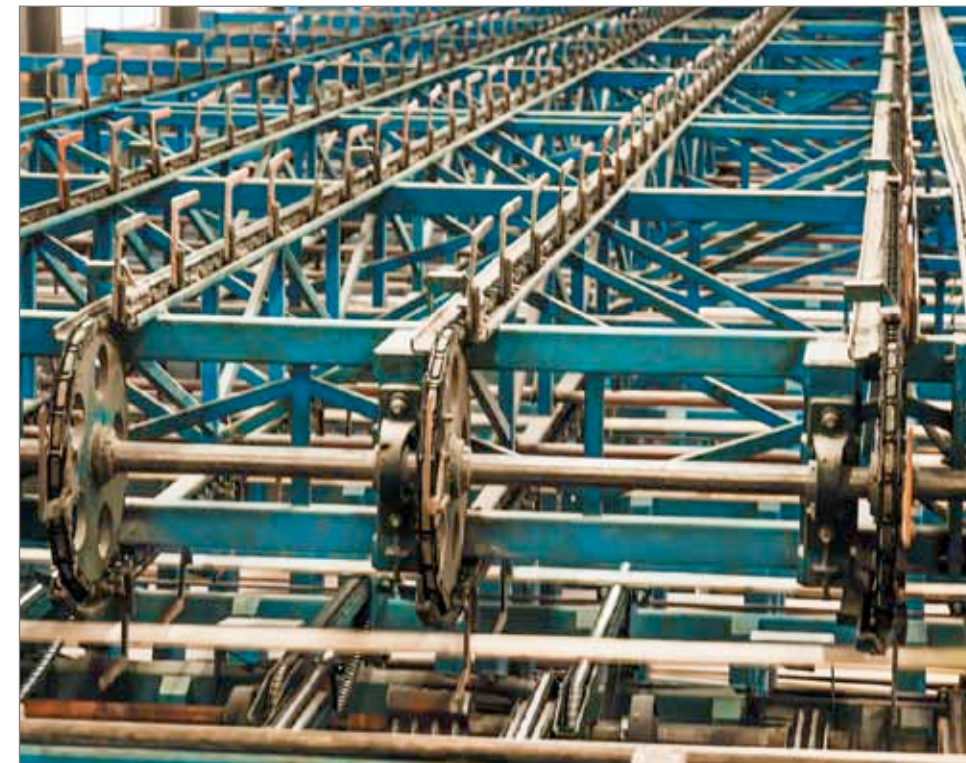
Рис. 17. Разные виды сортировочных конвейеров для вертикальных карманов: слева – с перемещением пиломатериалов крюками и сбросом в карман за счет опрокидывания крюка или выдвигания упора, снимающего сортимент с крюка (на фото – линия сортировки на Лесозаводе № 25); справа – с толканием пиломатериалов упорами и сбросом за счет открывания клапана кармана (на фото – линия Hekotek на заводе «Лесплитинвест»). Перемещение упорами является более перспективным решением, позволяющим достигать производительности до 250 штук в минуту
