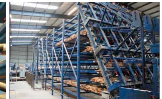
Рис. 18. Сортировочные конвейеры для распределения пиломатериалов по горизонтальным карманам: слева – вертикальный конвейер в линии Carbotech, пиломатериалы перемещаются на крюках элеватора сверху вниз, материал снимается с захватов выдвигающимися роликовыми шинами соответствующего кармана, по которым он соскальзывает на цепи; справа – наклонный конвейер в линии Brødbæk, пиломатериалы толкаются упорами наклонного конвейера, вход в карман закрыт клапаном, при раскрытии которого материал попадает внутрь, в противном случае проходит выше
