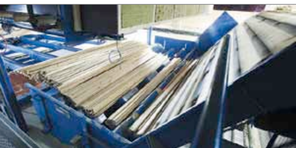
Рис. 1. Организация потока пиломатериалов на линии Renholmen комбинацией степ-фидера и дугообразного цепного конвейера. На упорах конвейера в итоге оказывается по одной доске. На выходе с каскада пиломатериалы образуют однослойный ковер
