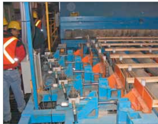
Рис. 8. В устройстве Opti-Gate от Carbotech заслонки не перемещаются с потоком, а устанавливаются в определенное положение и с определенным наклоном, чтобы плавно направлять сортимент в требуемую позицию относительно линии реза
