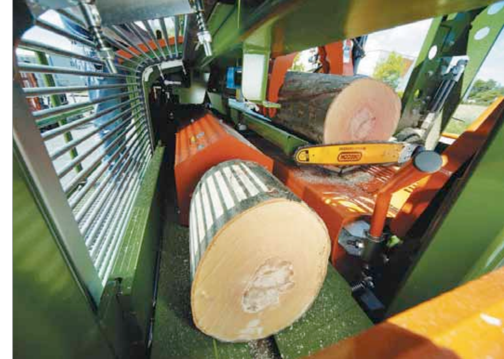
Рис. 2. Колода, отрезанная цепной пилой, сталкивается вбок и подается гидротолкателем на раскалывающий нож
