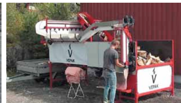
Рис. 9. Фасовочная машина Verak V1 (производитель – фирма Verack, Норвегия)
