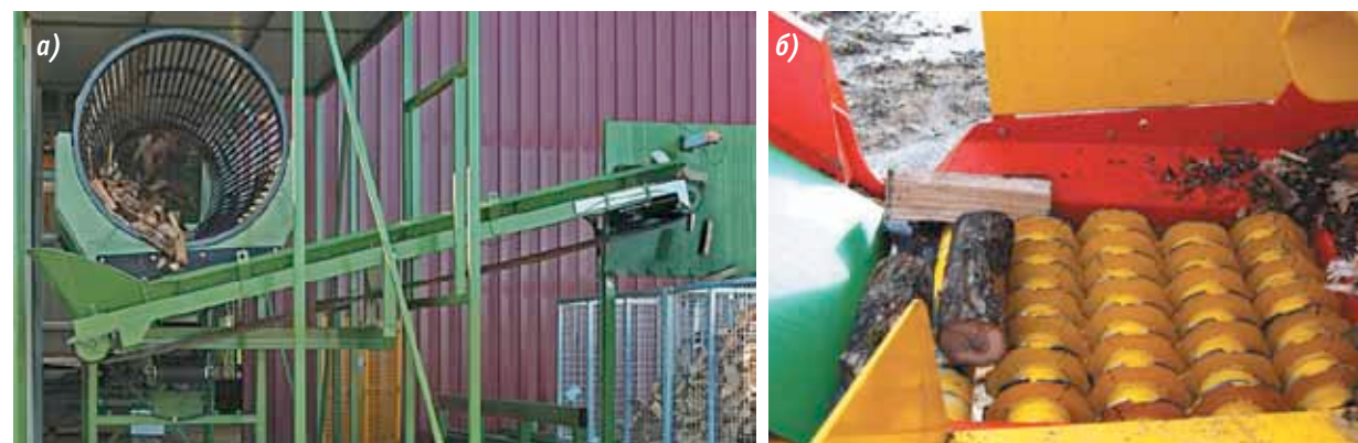
Рис. 7. Оборудование для удаления щепок и отпавшей коры: а – барабанное сито Pezzolato, б – дисковый сепаратор, встроенный позади дровокольного станка Rabaud
