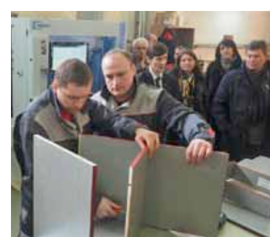
Пиление под углом детали по функции в меню станка «пиление с запасом под углом»
