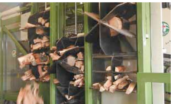
Рис. 5. Набор ножевых решеток процессора Pezzolato TLC 1500
