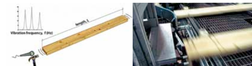
Рис. 2. Акустическая оценка класса прочности пиломатериалов
