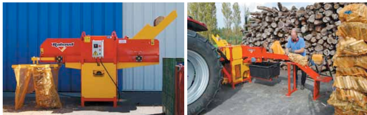
Рис. 11. Машины Rabaud Xyloflat для производства лучины и ее фасовки: с приспособлением для фасовки в сетку навалом и револьверным устройством быстрой замены сеток (слева) и с приспособлением для фасовки в сетку плотными пучками (справа)
