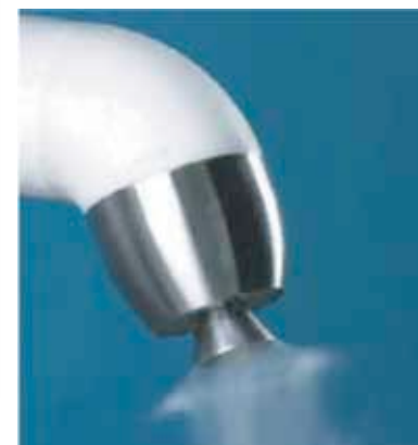
Рис. 13. Вид окрасочного факела центробежного электростатического распылителя
