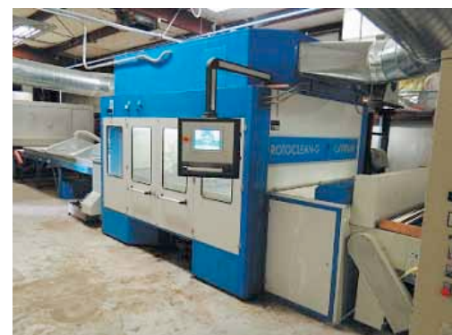
Рис. 11. Покрасочная камера Rotoclean G8 с каруселью пневматических форсунок (поставщик – компания «КАМИ-Станкоагрегат», Россия)
