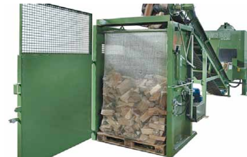
Рис. 10. Система фасовки в большие сетки и балк-бэги фирмы Pezzolato
