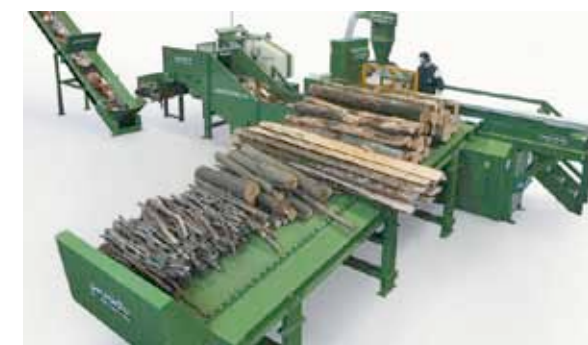
Рис. 4. Дровокольная линия Pezzolato с раздельными раскряжечным и раскалывающим станками: при обработке горбылей и веток используется только раскряжечный станок, сортименты подаются в него пачкой
