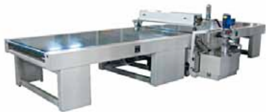
Рис. 14. Лаконаливная машина (производитель – компания Superfici, Италия)
