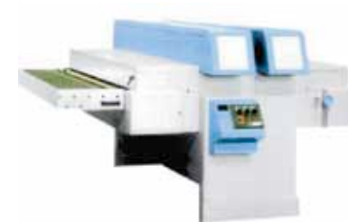
Рис. 16. Туннель УФ-сушки UVGZ (поставщик – компания «КАМИ-Станкоагрегат», Россия)
