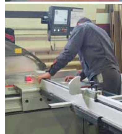
Пиление под углом детали по функции в меню станка «пиление с запасом под углом»
