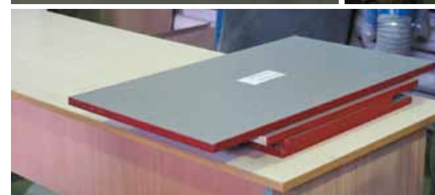
Раскрой плитного материала по управляющей программе
