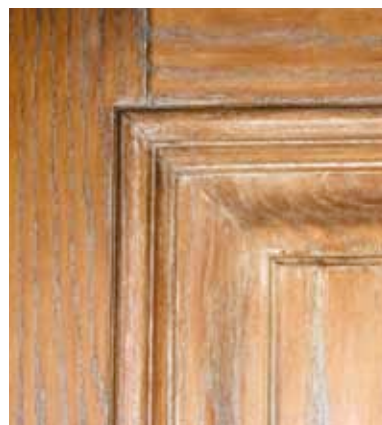
Рис. 2. Деревянные детали после искусственного старения
