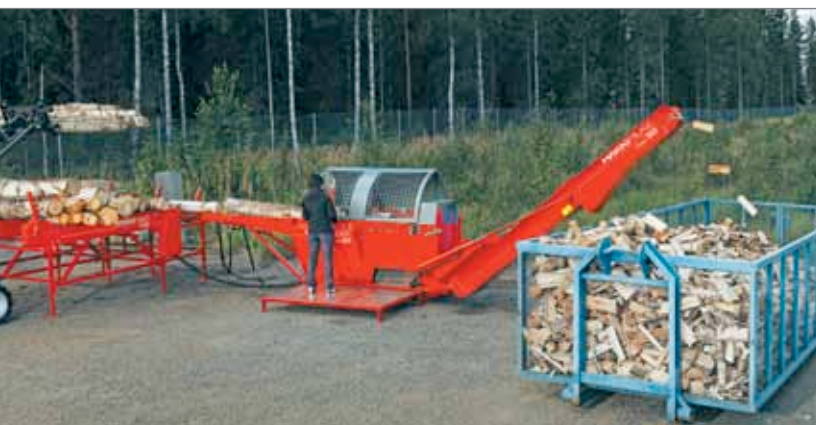
Рис. 1. Финские дровокольные станки: со столом подачи и накопителем (слева), с подъемником бревен (справа)
