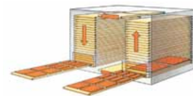
Рис. 15. Вертикальная конвективная сушильная установка Contivert ETC (производитель – компания Superfici / SCM, Италия)
