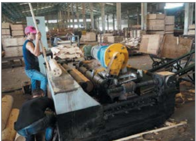
Рис. 8. Бесшпиндельный лущильный станок с цепным приводом роликов
