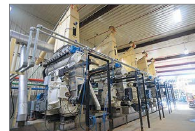
Рис. 9. На американском заводе Highland Pellet Plant четыре линии с пятью грануляторами Andritz PM30 каждая
