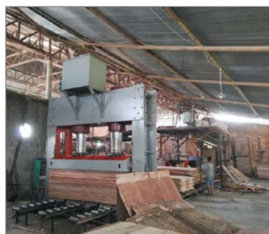
Рис. 16. Одноэтажный пресс китайского производства усилием 400 т для холодной подпрессовки пакетов фанеры
