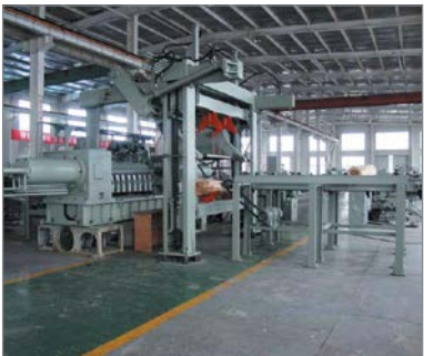
Рис. 7. Двухшпиндельный лущильный станок фирмы BSY с конвейером-накопителем и ЦЗУ с гидроприводом и системой управления Mitsubishi
