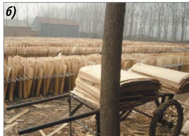
Рис. 10. Дыхательный пресс с симультаным механизмом для сушки шпона (а), атмосферная сушка шпона (б)
