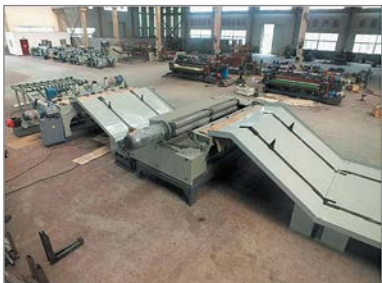
Рис. 9. Бесшпиндельный лущильный станок, сагрегированный с окорочным станком
