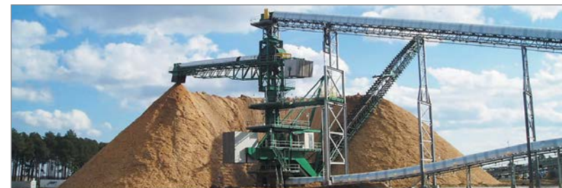
Рис. 6. Установка штабелирования и разгрузки сыпучих материалов Bruks COSR (Circular Overpile Stacker Reclaimer)
