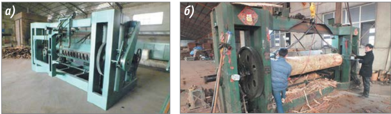
Рис. 6. Одношпиндельный лущильный станок (а), загрузка чурака в станок (б)
