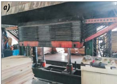
Рис. 10. Дыхательный пресс с симультаным механизмом для сушки шпона (а), атмосферная сушка шпона (б)
