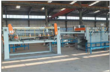
Рис. 13. Линия ребросклеивания шпона производства фирмы Shandong Jinlun Machinery Co., Ltd
