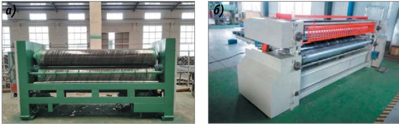
Рис. 14. Клеевые вальцы простейшей конструкции (а) и современные клеевые вальцы фирмы BSY (б)
