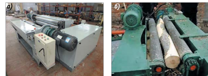
Рис. 5. Бесшпиндельный окорочный станок (а), окоривание сортимента (б)
