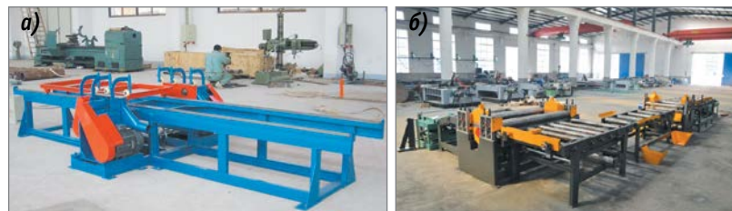
Рис. 18. Станок для двусторонней обрезки фанеры с ручной подачей каретки (а), автоматическая линия обрезки фанеры со станками для продольной и поперечной обрезки и перекрестной станцией (б)
