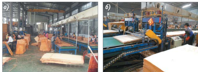
Рис. 15. Линии сборки пакетов на непрерывном ленточном конвейере (а), делительная пила для нарезания многослойной ленты шпона на пакеты (б)
