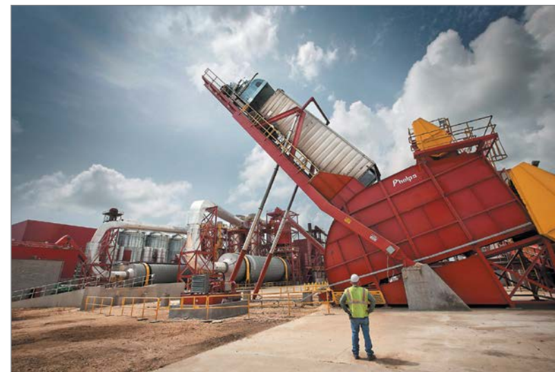
Рис. 6. Установка штабелирования и разгрузки сыпучих материалов Bruks COSR (Circular Overpile Stacker Reclaimer)
