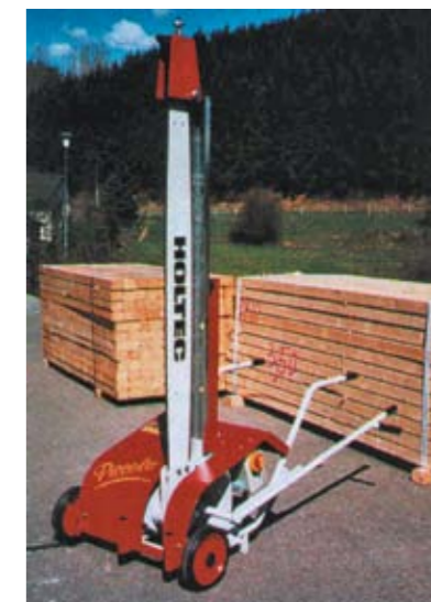
Рис. 2. Передвижная цепная пила с длиной реза 1–2,5 м для пакета пиломатериалов (Holtec)
