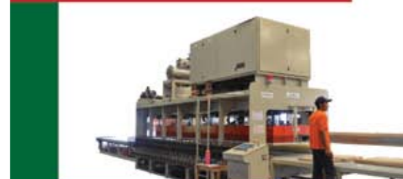
Высококачественный пресс тяжёлой серии для производства клеёной древесины
