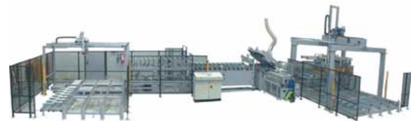
Линия для раскроя плит на полосы «штабель – штабель»
