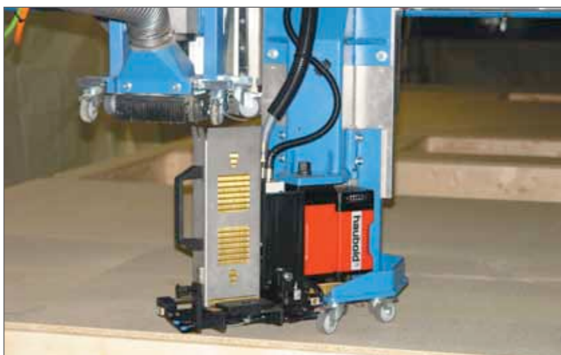
Рис. 4. Неиспользуемый агрегат поднимается вверх, освобождая пространство для используемой в данный момент техники
