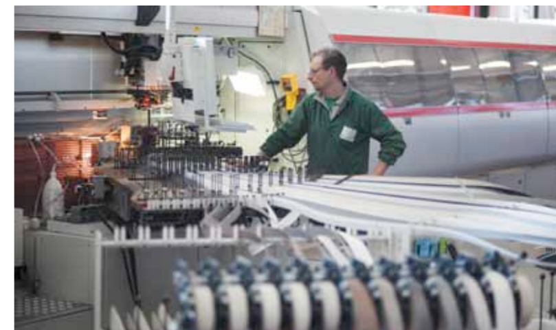
Индустриальный кромкооблицовочный станок IMA с магазином на 98 кромок и скоростью работы до 30 м/мин
