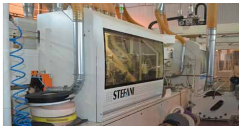
Форматно-кромкооблицовочный станок Stefani Evolution SSB (SCM Group)
