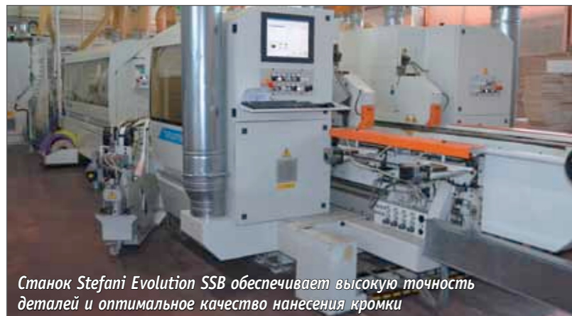
Промышленный форматно-кромкооблицовочный станок Stefani Evolution SSB (SCM Group)
