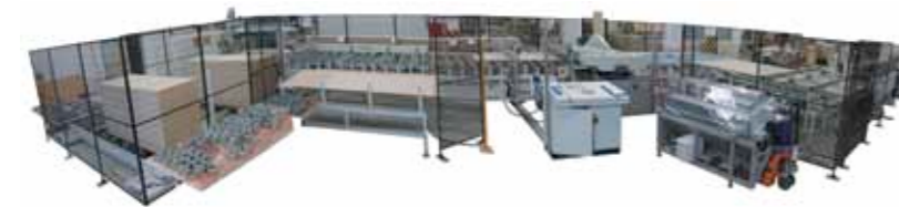
Линия для раскроя плит на полосы и их последующей загрузки в продольно-фрезерный станок
