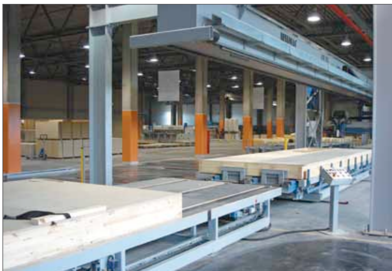
Рис. 5. Участок для изготовления элементов перекрытий и кровли
