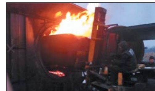
Рис. 17. Выгрузка реторты Ван Мариона из камеры на предприятии в г. Болевац, Сербия
