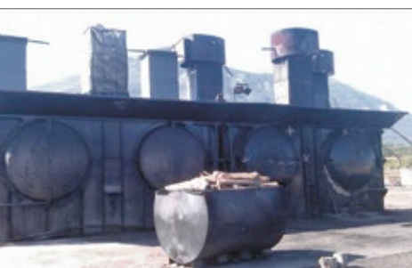
Рис. 15. Две установки VMR на предприятии в Сербии. На переднем плане реторта с дровами
