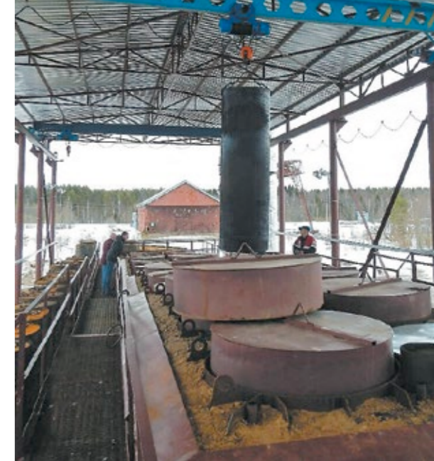
Рис. 12. В процессе работы установок «Эколон» все переместительные операции выполняются краном
