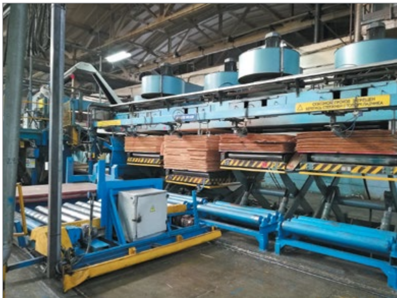
Пачки продольного шпона после лушения
