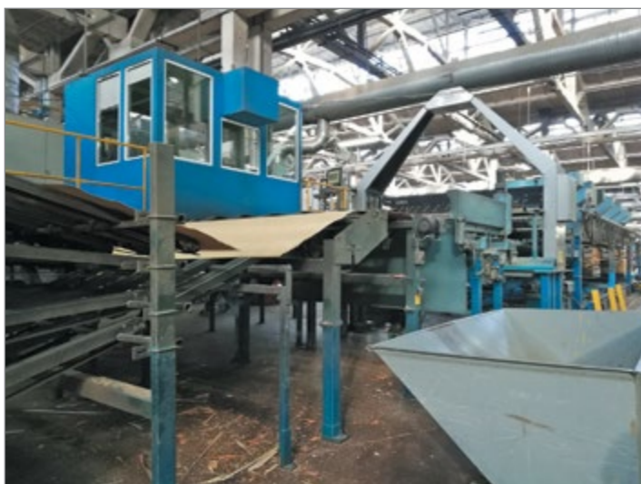
Сортировка и контроль влажности сухого шпона
