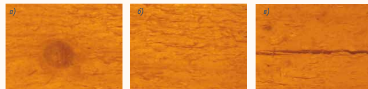
Рис. 2. Изображения участков с дефектом: а – участка с сучком; б – участка без дефектов; в – участка с трещиной
