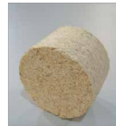
Цилиндрический брикет без радиального отверстия
