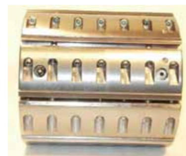
Рис. 2. Клинообразные планки с прямоугольными отверстиями с резьбой
