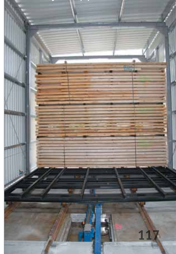
Автоматическая система загрузки тоннельной сушилки фирмы Mühlböck-Vanicek
