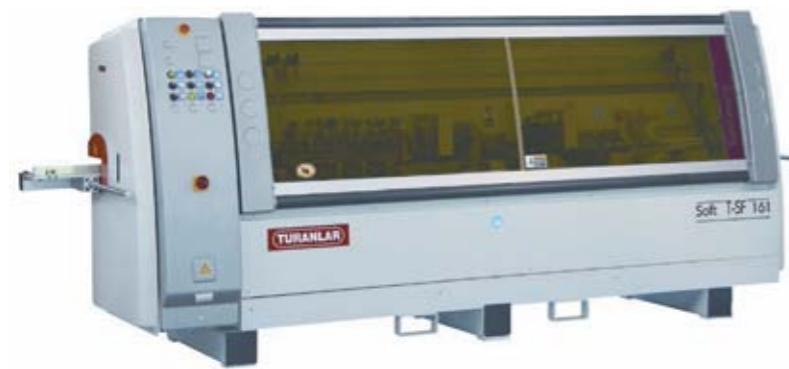
Рис. 3. Простой станок для облицовывания кромок способом софтформинга, не оснащенный агрегатами для фрезерования кромочного профиля
