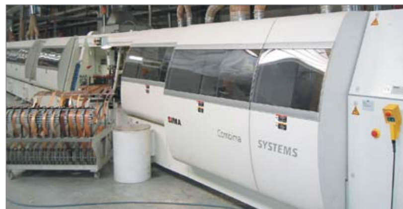
Рис. 4. Мощный станок для облицовывания плоских и профильных прямолинейных кромок методом софтформинга
