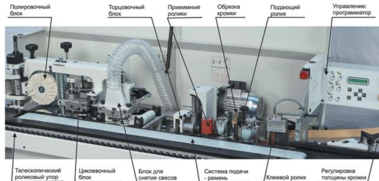
Рабочие агрегаты автоматического кромкооблицовочного станка Ala 20 Plus (Casadei, Италия)
