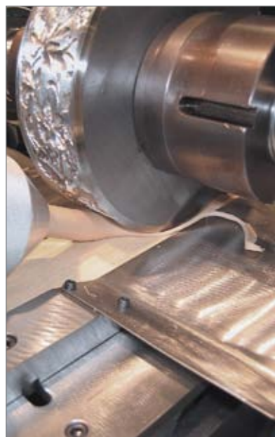
Рис. 1. Выдавливание пасты и накатывание роликом рельефа на погонаже
