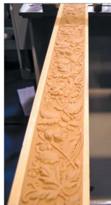
Рис. 2. Погонаж с тисненым рельефом на выходе из станка
