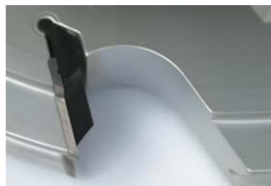
Рис. 4. Затяжная зажимная система без острых углов вставного паза, как, например, ProfilCut от Leitz
