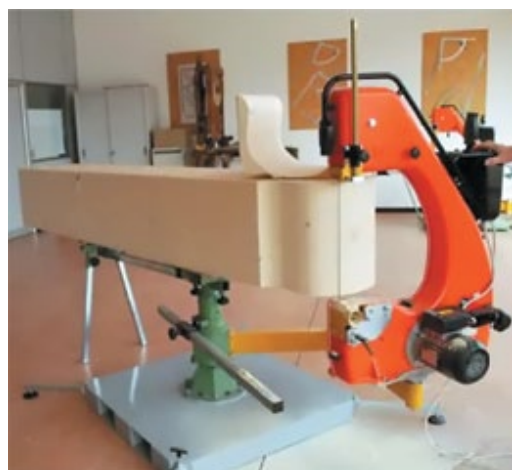
Рис. 3. Ленточно-пильный станок фирмы MD Dario для выполнения криволинейных пропилов на крупных заготовках
