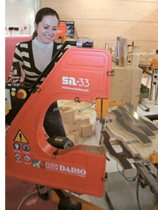
Рис. 4. Ленточно-пильный станок SN-33 с копиром. Копир, перемещаясь по периметру лекала, позволяет с точностью повторять исходную заготовку со значительной экономией времени
