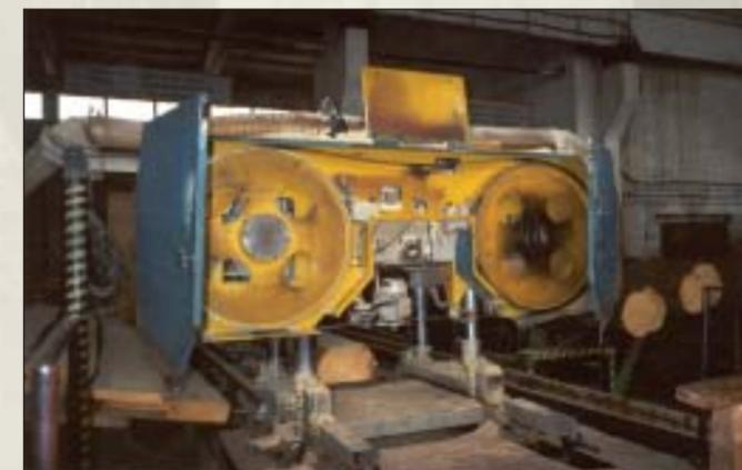
Рис.8 Горизонтальный ленточнопильный станок «ЛГУ-1000»
