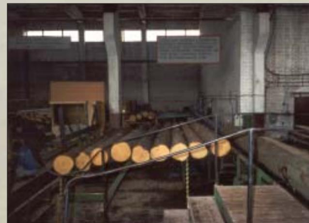
Рис.11 Накопительный конвейер перед ленточнопильным станком
