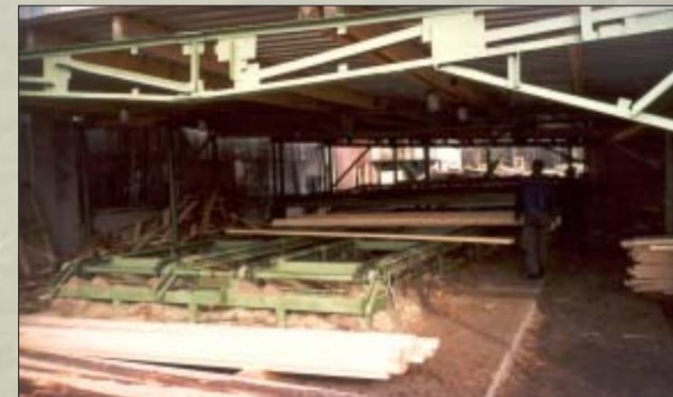
Рис.4 Сортировочный транспортер для пиломатериалов
