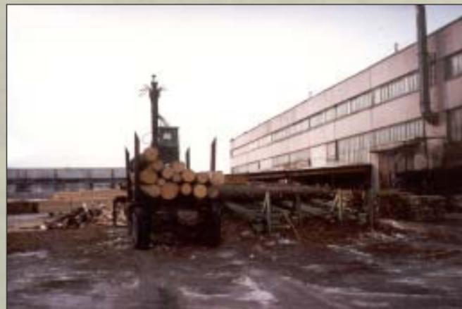
Рис.1 Загрузка бревен на цепной транспортер
