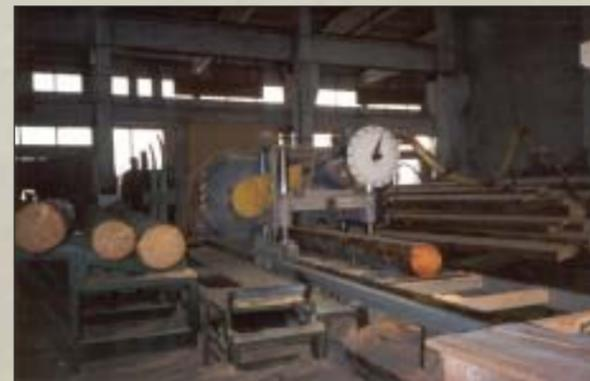
Рис.3 Слева видны загрузочная эстакада с устройством поштучной выдачи бревен, а также ленточный конвейер для отвода необрезных досок и горбылей.
