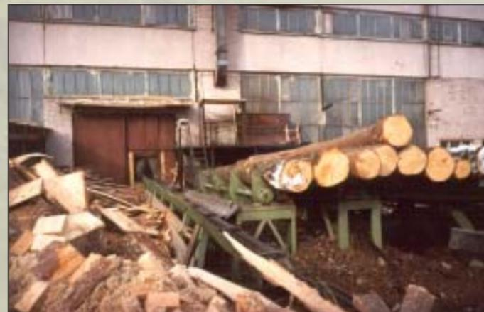
Рис.2 Устройство поштучной выдачи бревен
