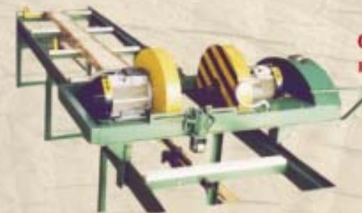
**Станок двухпильный кромкообрезной ЦОД-450**
