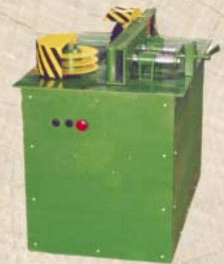
Круглопильный станок предназначен для глубокой переработки пиломатериала, обеспечивает максимальный выход деловой древесины. Станок используется для переработки отходов древесины (горбыль) оставшихся после распиловки круглого леса, а также после обрезки досок. Продукты выхода: доска, рейка, брус.
