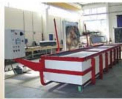
В пресс-вакуумных камерах воплощены самые передовые методы сушки древесины, которые позволяют производить сушку древесины в 8-10 раз быстрее, чем в традиционных сушилках. Помимо вакуума используется эффект давления на штабель с усилием до 10 000 кг/м<sup>2</sup>, которое создается с помощью специальной мембраны. Доска в процессе сушки не деформируется, а выравнивается, уменьшая количество бракованной продукции. Данное преимущество особенно очевидно при работе с ценными породами древесины.
