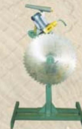
**Заточной станок для дисковых пил УЗС-2**
