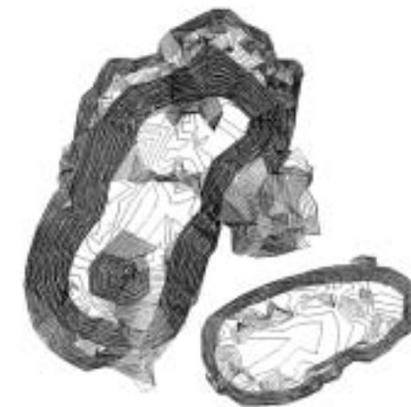
Рис. Фрагмент плана в горизонталях кучи технологической щепы
