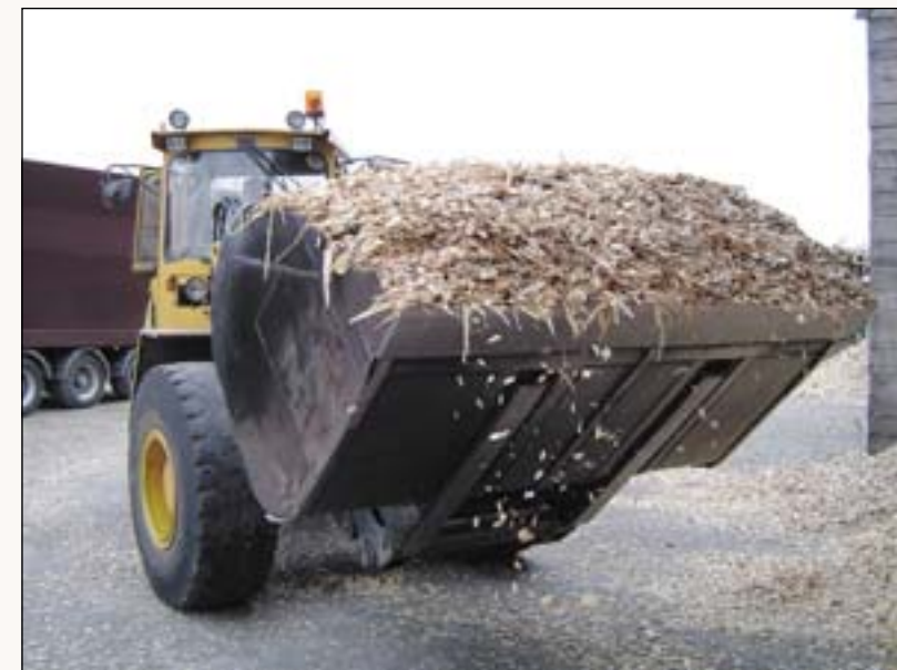
Погрузка щепы ковшевым погрузчиком
