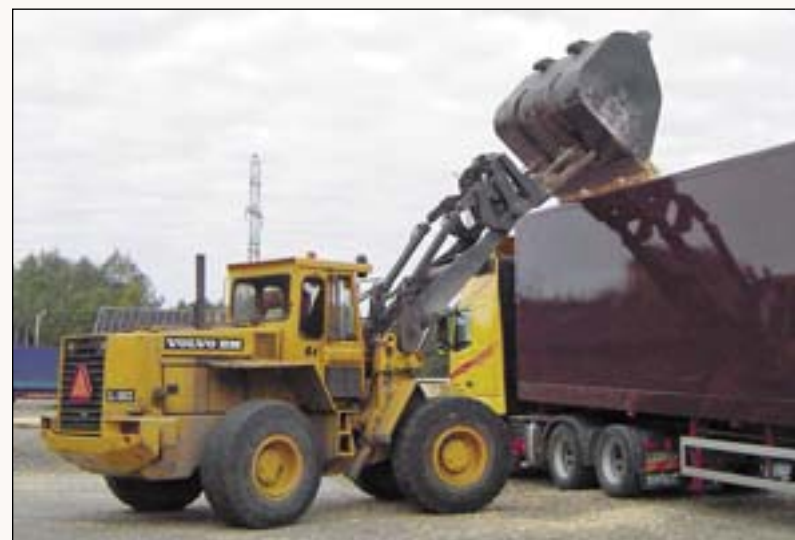
Погрузка щепы в автощеповоз
