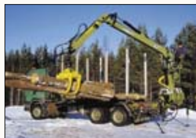
Манипуляторами оборудована вся лесозаготовительная техника: харвес-
