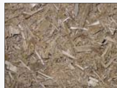
Ориентированно-стружечная плита (ОСП)
