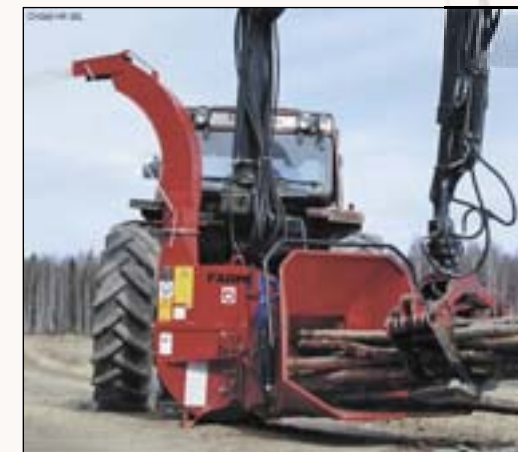
Современная мобильная рубительная установка CH260 HF-2EL (Финляндия)
