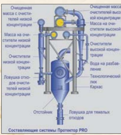
Схема двухступенчатой грубой очистки ММ в гидроциклонах – система «Протектор PRO»
