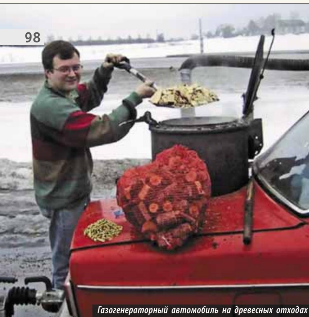
Газогенераторный автомобиль на древесных отходах
