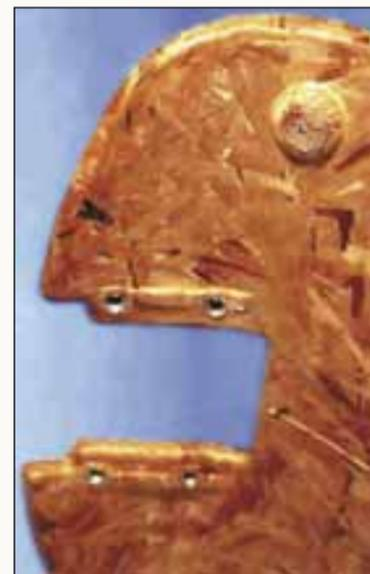
Рис. 11. Гнутоклееная деталь из OSB
