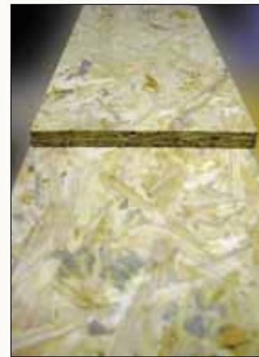
Рис. 6. Шлифованные плиты класса OSB/3
