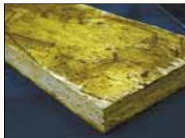
Рис. 1. OSB – конструкционный материал из древесины
