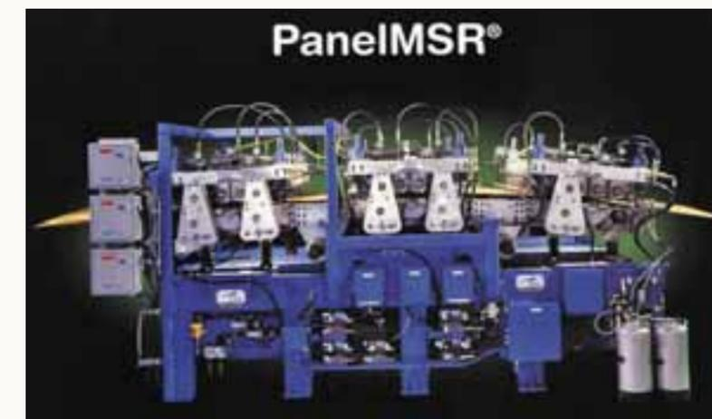
Рис. 12. Установка непрерывного контроля физико-механических характеристик OSB (производитель «Кармана», Канада)
