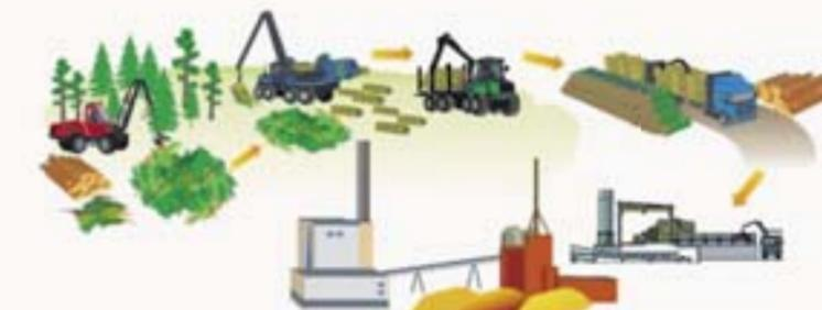
Рис. 7. Оптимизированная структура процесса заготовки щепы
