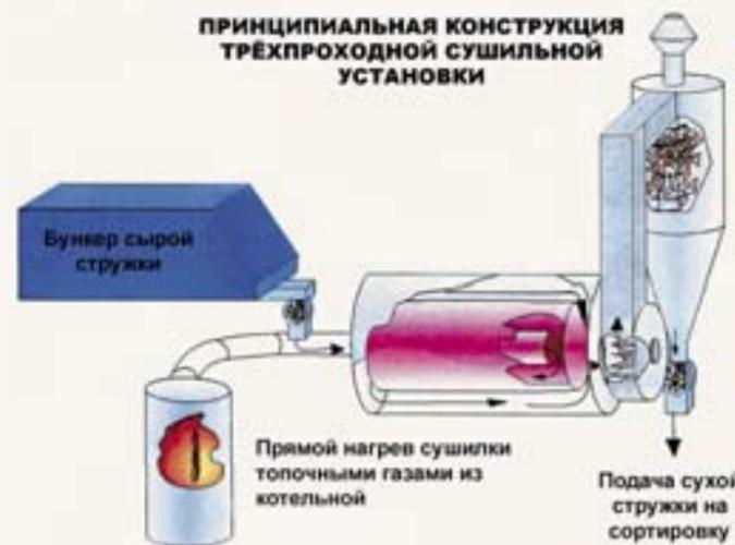
Рис. 6. Принцип действия трехпроходной сушильной установки, в которой сушили стружку для вафельных плит и OSB
