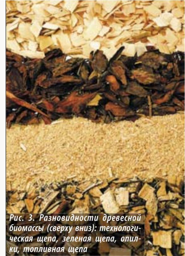
Рис. 3. Разновидности древесной биомассы (сверху вниз): технологическая щепка, зеленая щепка, опилки, топливная щепка
