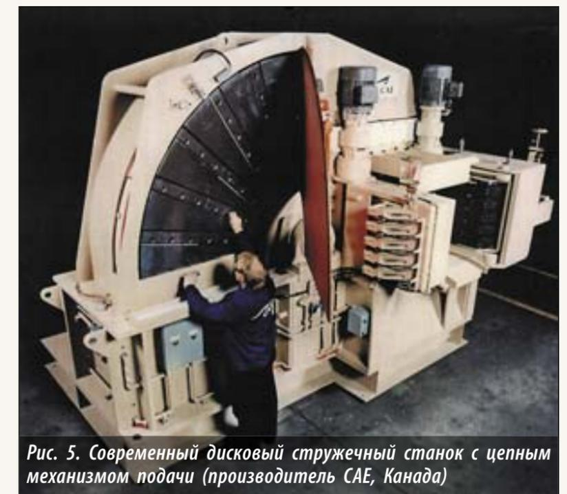
Рис. 5. Современный дисковый стружечный станок с цепным механизмом подачи (производитель CAE, Канада)
