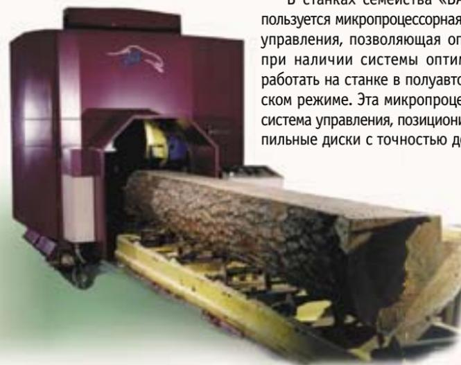
В станках семейства «БАРС» используется микропроцессорная система управления, позволяющая оператору при наличии системы оптимизации работать на станке в полуавтоматическом режиме. Эта микропроцессорная система управления, позиционирующая пильные диски с точностью до 0,1 мм,
