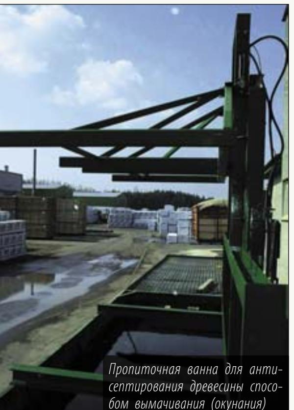
Пропиточная ванна для антисептирования древесины способом вымачивания (окунания)
