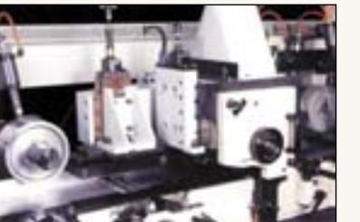
безлюфтовые редукторы посредством карданной передачи. Запатентованная система подачи обеспечивает плавную и стабильную подачу заготовок со скоростью в диапазонах 10–100 м/мин., 12–120 м/мин., 15–150 м/мин., 20–200 м/мин.
