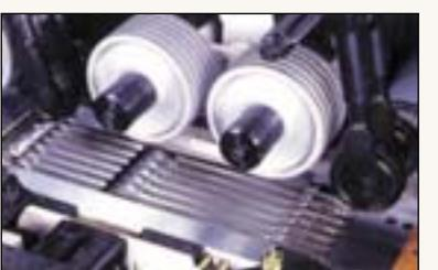
на минимальную величину. Даже при касании режущего инструмента о прижимные фторопластовые плиты он не будет поврежден. Использование обрезиненных роликов исключает образование следов на МДФ от резистной поверхности металлических подающих роликов. Изготовленные на таком станке изделия из МДФ не требуют последующей шлифовки (при условии, что на станке установлен качественный инструмент, который правильно заточен и доведен методом прифуговки).
