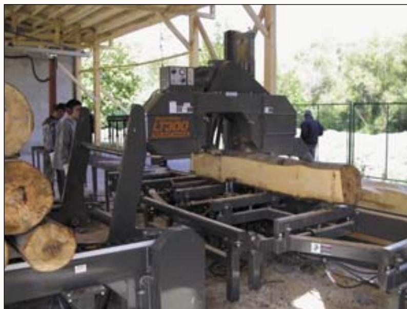
Комплекс LT300 на производстве фирмы «Вита-02» в Болгарии. В зависимости от породы древесины, размера бревен и схемы раскroя здесь распиливают от 2,0 до 4,5 м<sup>3</sup> в час
