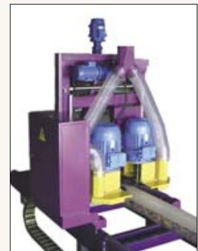
Для небольших диаметров пиловочника НПО «Барс» был разработан и запущен в серийное производство станок двухдисковый горизонтальный «Барс-ДГ».
