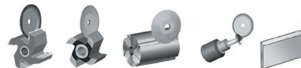
Рис. 13. Схемы заточки разного инструмента в универсальном станке Ironmac 163
