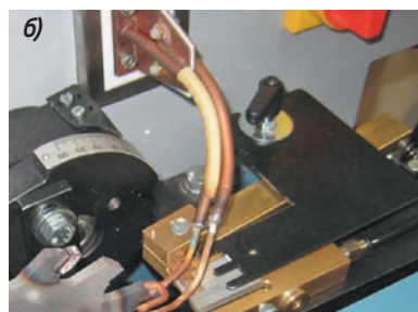
Рис. 2. Пайка инструментов: а – круглой пилы; б – насадной пазовой фрезы
