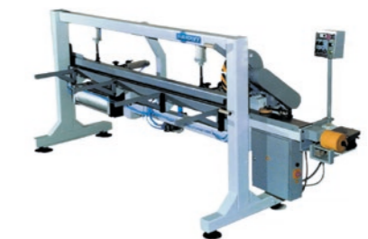
Пресс одноканальный для сращивания заготовок СПР 002М-3200 (Бакаут) Предназначен для нанесения клея, подачи заготовок вручную, запресовка и торцевание – полуавтоматические. Производительность до 6 пог. м/мин. Габаритные размеры 4,7 × 1,1 × 1,5 м. Максимальная длина склеенного бруса 3200 мм.
