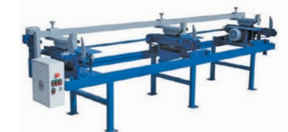
Проходная торцовка ТСП-50 («Стилет», Владимирская обл.) Предназначена для чистового торцевания заготовок и вырезки дефектных участков. Высота пропила до 50 мм. 2–6 пильных узлов. Максимальная длина заготовки 3300 мм, максимальная ширина – 250 мм.
