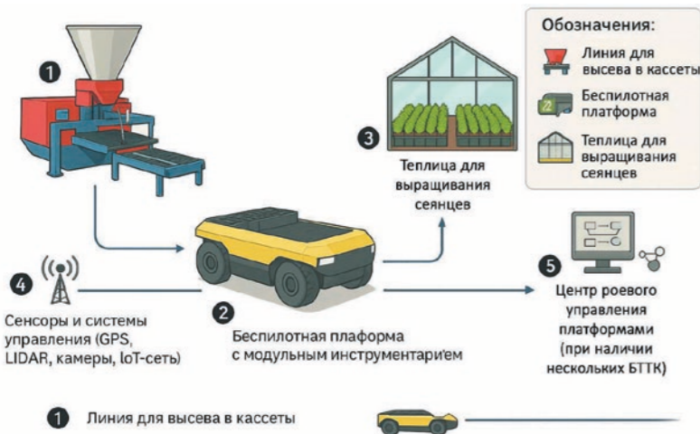
Схема работы беспилотной платформы в лесном питомнике
