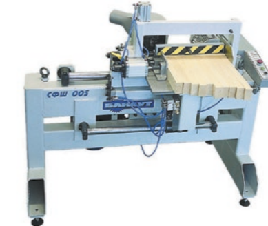
Станок фрезерный СФС 005 (Бакаут) Предназначен для формирования минишипов на торцах заготовок для сращивания по длине. Длина заготовки 200–730 мм, высота 15–150 мм.
