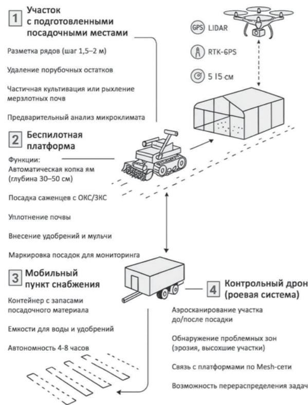
Схема работы беспилотной платформы при лесовосстановлении
