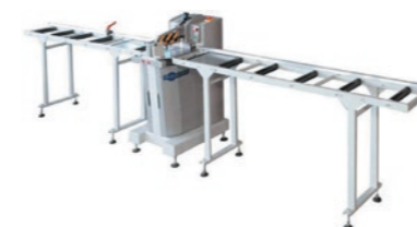
Торцовочный станок СТБ-002-01 (Бакаут) Предназначен для раскроя материала на черновые заготовки, вырезки недопустимых дефектов. Макс. сечение заготовки 250 × 50 мм или 200 × 100 мм. Пила диаметром 400 мм
