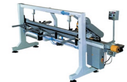
Пресс одноканальный для сращивания заготовок СПР 002М-3200 (Бакаут) Предназначен для нанесения клея, подача заготовок вручную, запресовка и торцевание – полуавтоматические. Производительность до 6 пог. м/мин. Габаритные размеры 4,7 × 1,1 × 1,5 м. Максимальная длина склеенного бруса 3200 мм.
