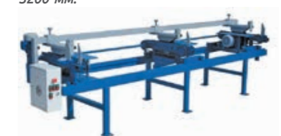
Проходная торцовка ТСП-50 («Стилет», Владимирская обл.) Предназначена для чистового торцевания заготовок и вырезки дефектных участков. Высота пропила до 50 мм. 2–6 пильных узлов. Максимальная длина заготовки 3300 мм, максимальная ширина – 250 мм.
