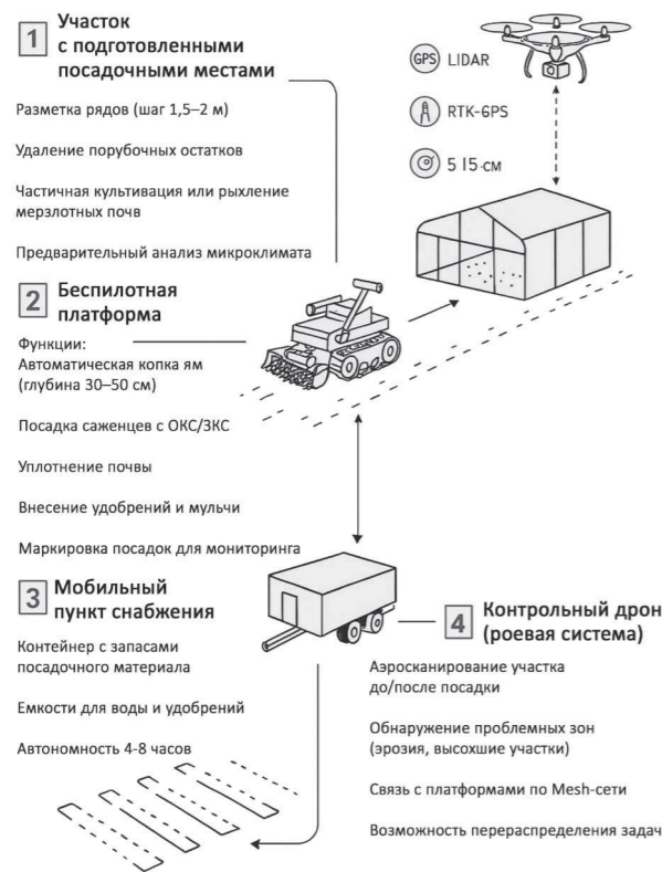
Схема работы беспилотной платформы при лесовосстановлении
