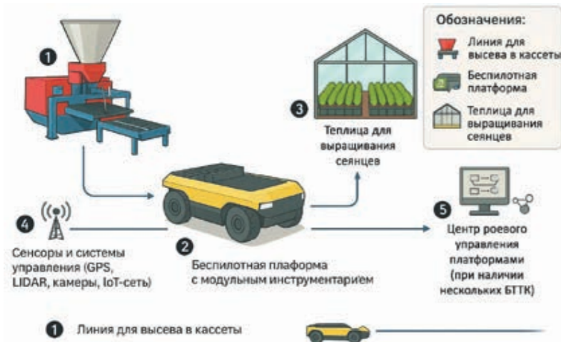
Схема работы беспилотной платформы в лесном питомнике
