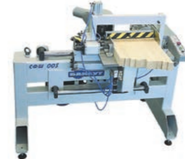
Станок фрезерный СФШ 005 (Бакаут) Предназначен для формирования минишипов на торцах заготовок для сращивания по длине. Длина заготовки 200–730 мм, высота 15–150 мм.
